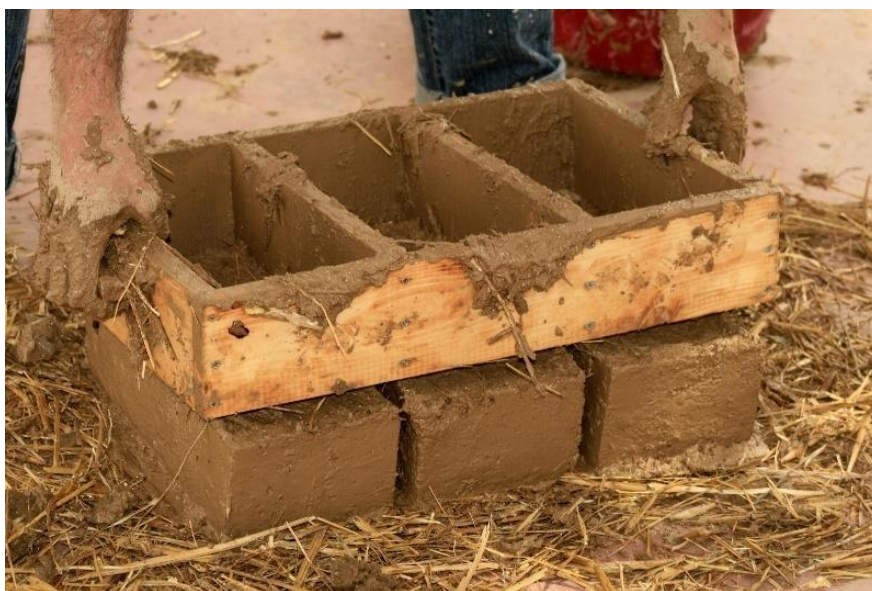
Εικ.3-33: Κατασκευή και αποστολή ξύλινης μήτρας για δημιουργία πλίνθων στη Γάζα, σε συνεργασία με την ΜΚΟ «Αρχιτεκτονική χωρίς Σύνορα», Αθήνα, Μάιος, 2010. (Πηγή: www.engoe.gr )
