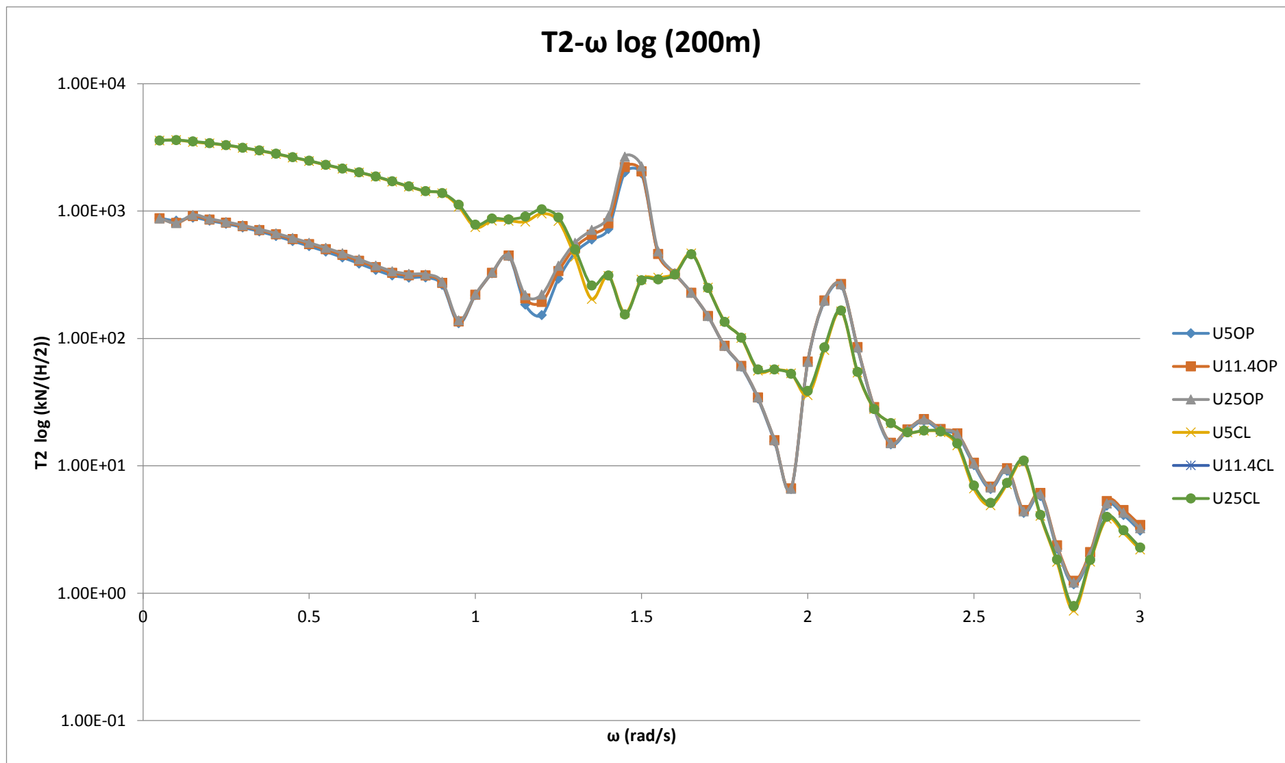
Εικόνα 6.33. Λογαριθμική τάση στον κλάδο αγκύρωσης του ανωστικού σώματος 2 ( T2 ) σε \text{kN} για βάθος αγκύρωσης 200m , για ταχύτητες ανέμου 5, 11.4, 25 \text{m/s} και για περιπτώσεις λειτουργίας-Closed (CL) και μη λειτουργίας-Opened (OP) των ανωστικών σωμάτων ως OWC's
