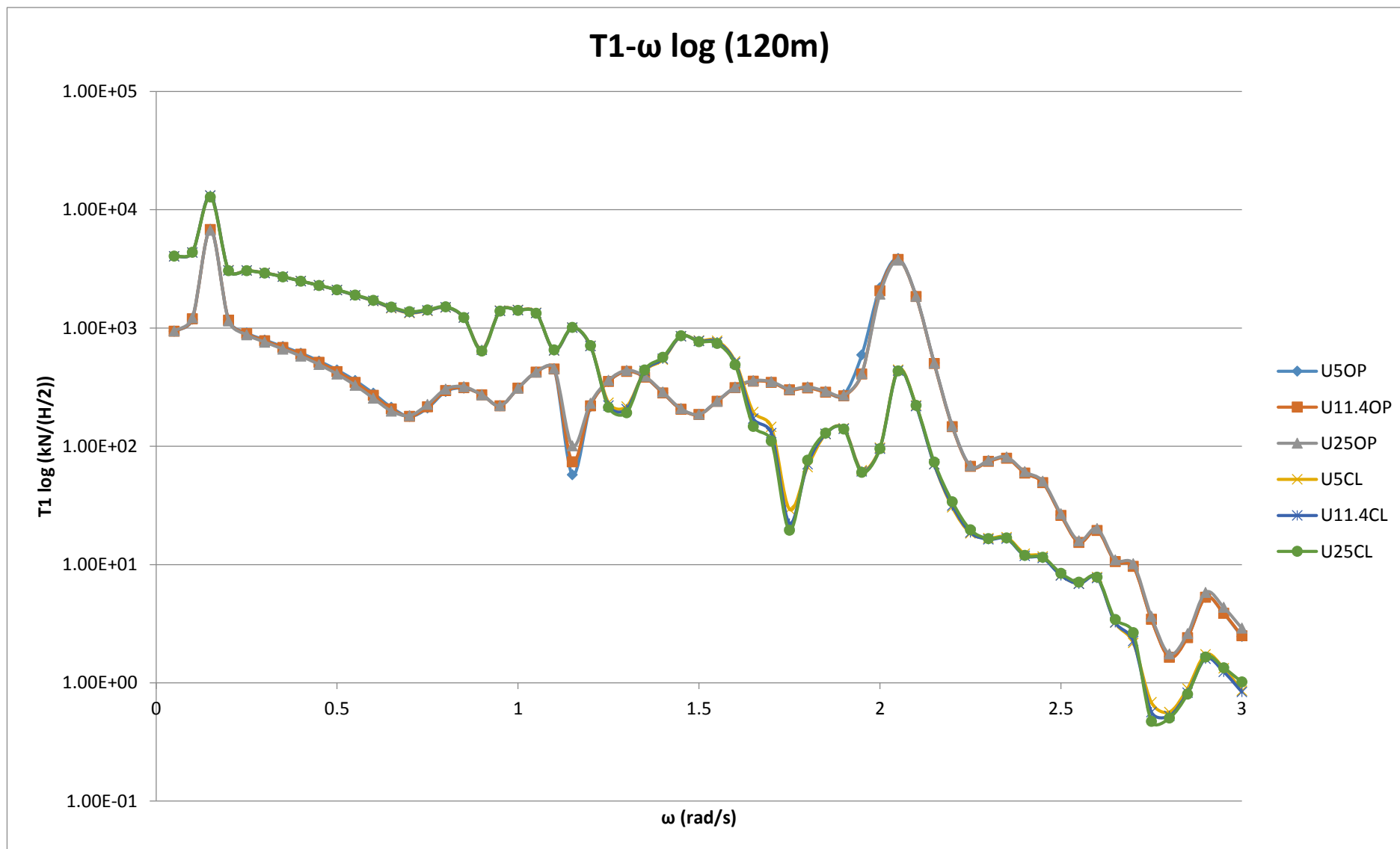
Εικόνα 6.27. Λογαριθμική τάση στον κλάδο αγκύρωσης του ανωστικού σώματος 1 ( T_1 ) σε kN για βάθος αγκύρωσης 120m , για ταχύτητες ανέμου 5, 11.4, 25 m/s και για περιπτώσεις λειτουργίας-Closed (CL) και μη λειτουργίας-Opened (OP) των ανωστικών σωμάτων ως OWC's
