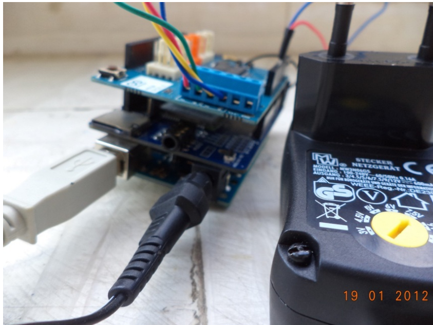
Εικόνα 3.27 Τροφοδοσία Arduino και Σύνδεση με Υπολογιστή
