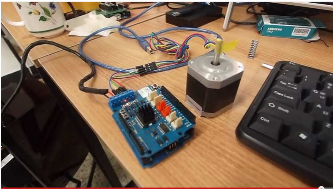
Εικόνα 3.26 Συνδεσμολογία Βηματικού Κινητήρα SM-42BYG011-25
