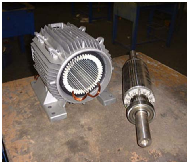
Εικόνα 2.12. Εσωτερικό ασύγχρονου κινητήρα στην οποία διακρίνονται όλα τα δομικά του στοιχεία.
