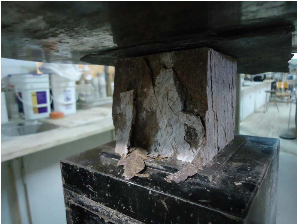
Εικόνα 75: Μετά τη ρηγμάτωση (2)
