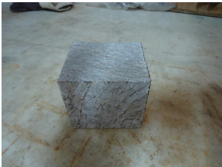
Εικόνα 72: Δοκίμιο σχιστολίθου πριν τη δοκιμή θλίψης
