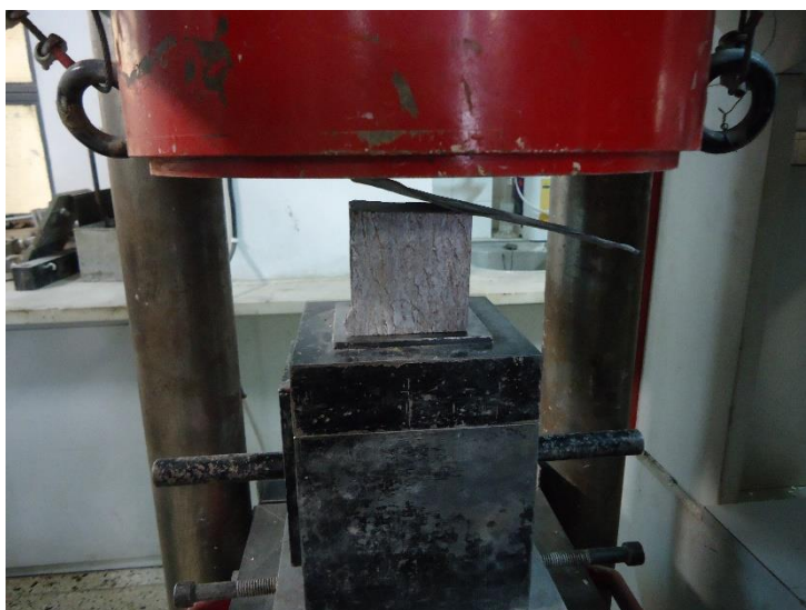
Εικόνα 73: Το δοκίμιο στην πρέσα θλίψης
