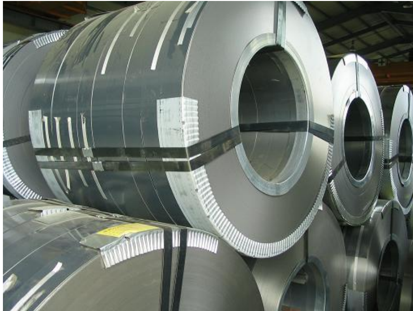
Εικόνα 1-1: Ηλεκτρικός χάλυβας σε κουλούρες
