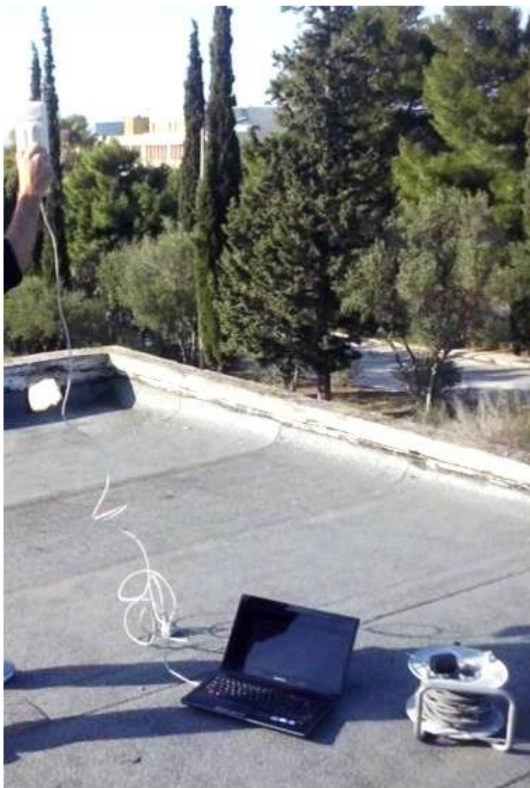
Εικόνα 7.6:3 Έλεγχος σημείου με το ισχυρότερο σήμα λήψης/εκπομπής
