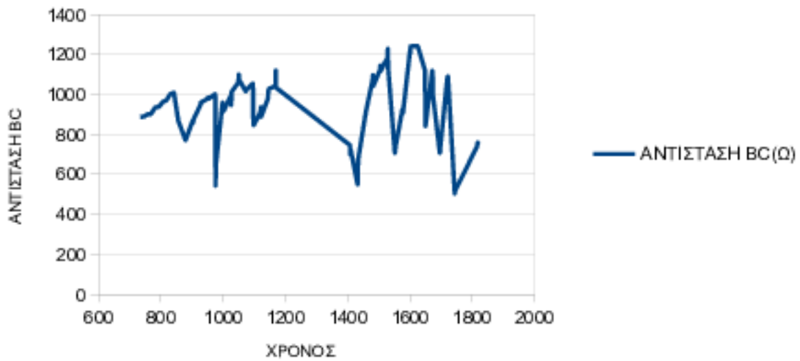
Εικόνα 25: Μετρήσεις αντίστασης BC συναρτήση του χρόνου με αισθητήρα 5% CNTs σε περιβάλλον NaCl 3.5%
