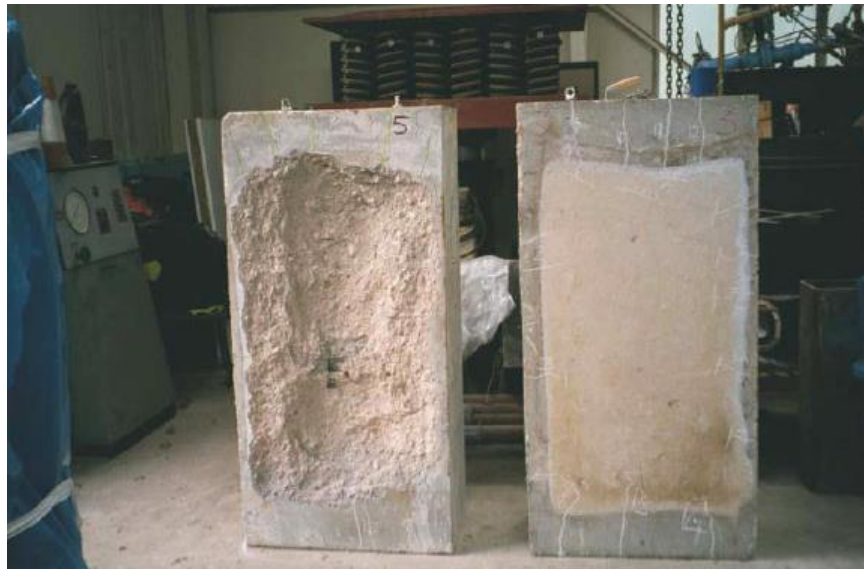
Εικόνα 3.20: Πυροπροστασία σκυροδέματος με ίνες πολυπροπυλενίου [Αγγελόπουλος et al,2005].
