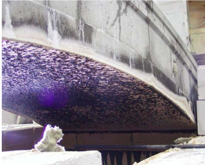
Εικόνα 3.17: Έκθεση πλάκας σκυροδέματος με ίνες πολυπροπυλενίου σε θερμοκρασία 1200^{\circ}\text{C} . [Haack,2004]
