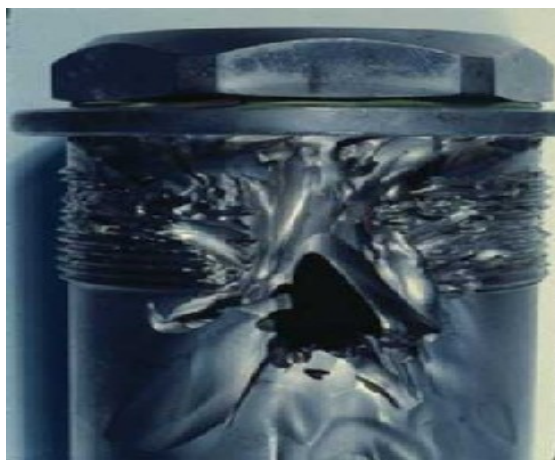
Σχήμα 1.3.6: Ρευστομηχανική διάβρωση εξαιτίας γρήγορης κίνησης υγρού σε βαλβίδα λαδιού[45]
