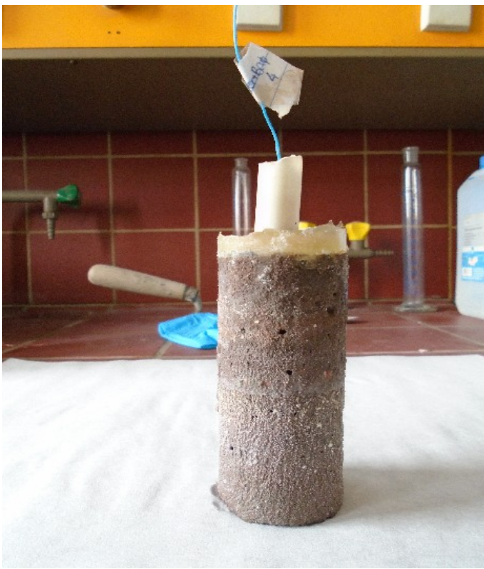
Εικόνα 9.3. Τα δοκίμια πριν την αφαίρεση του σκυροδέματος, και οι οπλισμοί πριν την ζύγιση.
