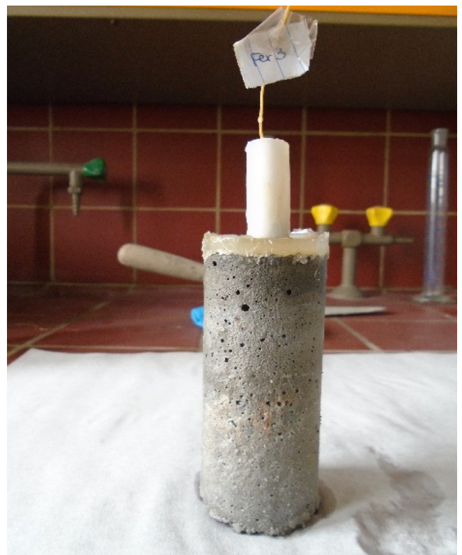
Εικόνα 9.3. Τα δοκίμια πριν την αφαίρεση του σκυροδέματος, και οι οπλισμοί πριν την ζύγιση.
