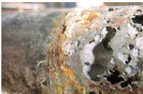
Σχήμα 1.3.15: Κομμάτι ατράκτου πλοίου που υπόκεινται σε διάβρωση από ρεύματα διαφυγής. Η ομαλή κοίλανση της επιφάνειας και οι μικροσκοπικοί πόροι είναι χαρακτηριστικοί στην διάβρωση από ρεύματα διαφυγής του ανοξειδώτου χάλυβα 157
