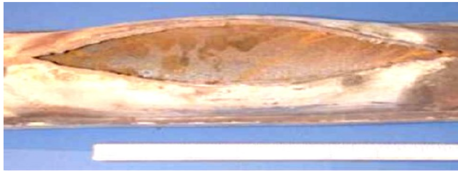
Σχήμα 1.3.12 : Βλάβη από υδρογόνο [60]
