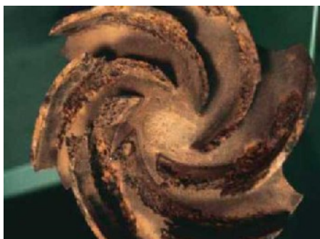
Σχήμα 1.3.7: Σπηλαιώδης διάβρωση σε μεταλλική φυγοκεντρική αντλία [46]
