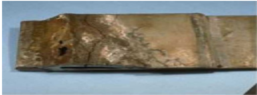
Σχήμα 1.3.11 : Διάβρωση λόγω μηχανικής καταπόνησης σε υψηλά κραματοποιημένο χάλυβα συγκόλλησης[54]
