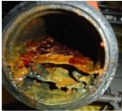
Σχήμα 1.3.14: Αποτελέσματα βιολογικής διάβρωσης[64]
