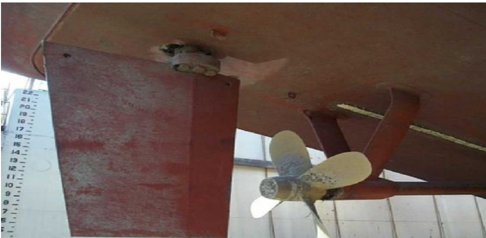
Εικόνα 1.6.1.2: Διάβρωση πηδαλίου και έλικας λόγω θαλασσινού περιβάλλοντος
