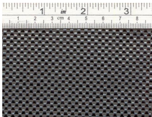
Σχήμα 2.4: Ανθρακοϋφασμα με πλέξη Plain Weave.
