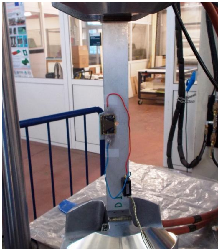
Σχήμα 3.4: Δοκίμιο αναφοράς τοποθετημένο στην υδραυλική μηχανή MTS.
