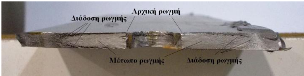
Σχήμα 4.6: Τομή του δοκιμίου αναφοράς DR-2 (μη ενισχυμένο) μετά την αστοχία.
