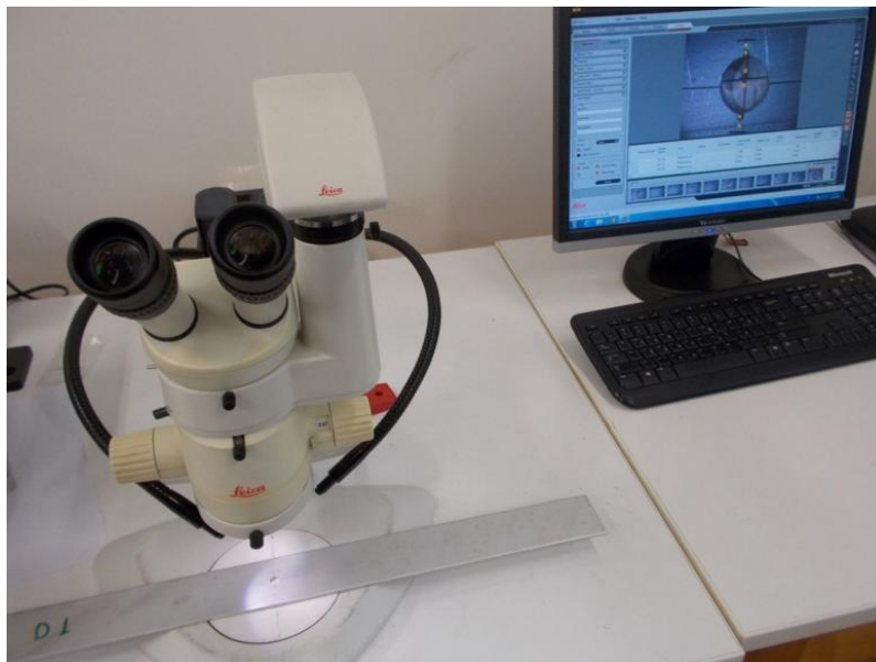
Σχήμα 3.7: Μέτρηση δοκιμίου με το στερεοσκόπιο LEICA MZ6.
