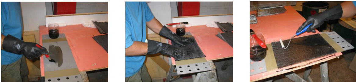
Σχήμα 1.2: Διαδικασία επίστρωσης με το χέρι (HLU) σύνθετου επιθέματος σε πειραματικά δοκίμια. (πηγή: Co-Patch D5.1)
