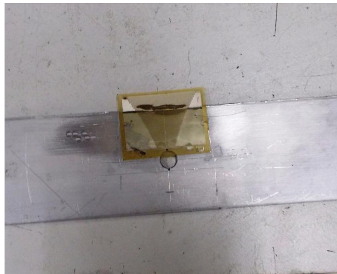
Σχήμα 3.3: Τοποθέτηση crackgagε μετά την λείανση της επιφάνειας.
