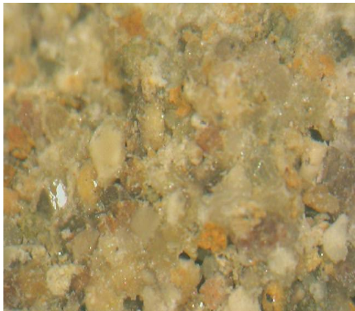
Σχήμα 4.11: Εικόνες Μικροσκοπίας Οπτικών Ινών (FOM) από δείγματα Γκρίζου Πορώλιθου Ρόδου στην επιφάνεια τομής, 50x.
