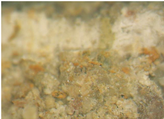
Σχήμα 4.10: Εικόνες Μικροσκοπίας Οπτικών Ινών (FOM) από δείγματα Γκρίζου Πορώλιθου Ρόδου.
