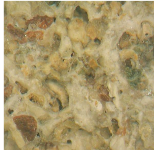
Σχ. 4.10.η. Rh3 – κατεργασμένο δείγμα, 50x (διεπιφάνεια στερέωσης)
