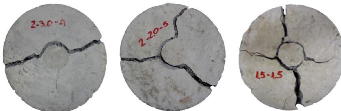
Σχήμα 14: Απεικόνιση των ρωγμών που προκαλούνται στα κυλινδρικά δοκίμια. (Carmona Sergio, Aguado Antonio, Molins Climent, 2013)
