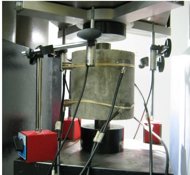
Σχήμα 24: Απεικόνιση της διάταξης δοκιμής Barcelona.
