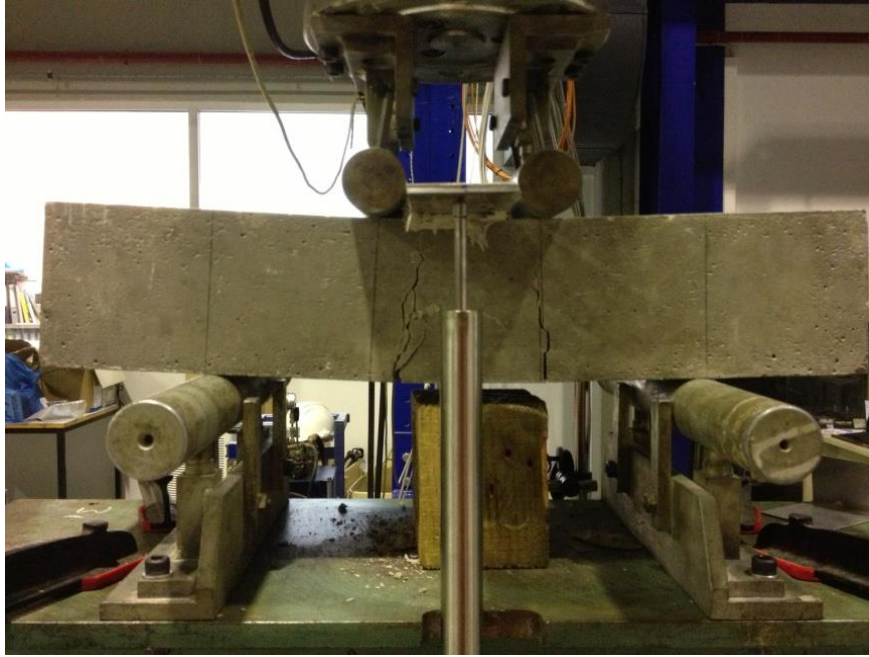
Σχήμα 70: Μορφή αστοχίας όταν η φέρουσα ικανότητα δεν ορίζεται από την τιμή του πρώτου μέγιστου φορτίου.
