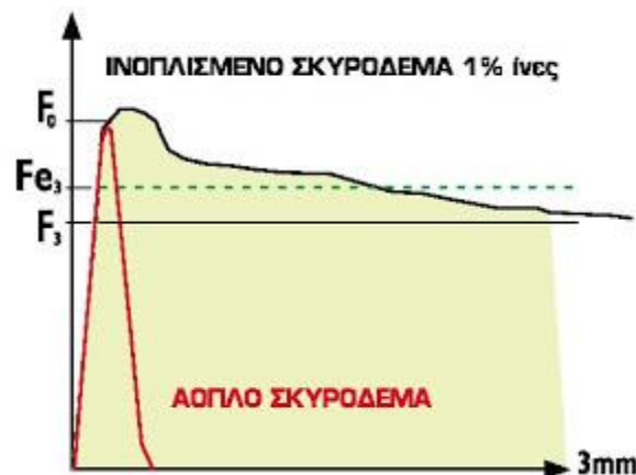
Σχήμα 1: Καμπύλη φορτίου-παραμόρφωσης για άοπλο και ινοπλισμένο σκυρόδεμα.
