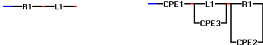
Εικόνα 60 Ισοδύναμο κύκλωμα για μεταλλικούς αγώγιμους δρόμους (αριστερά) και για το δείγμα 3h (δεξιά)
