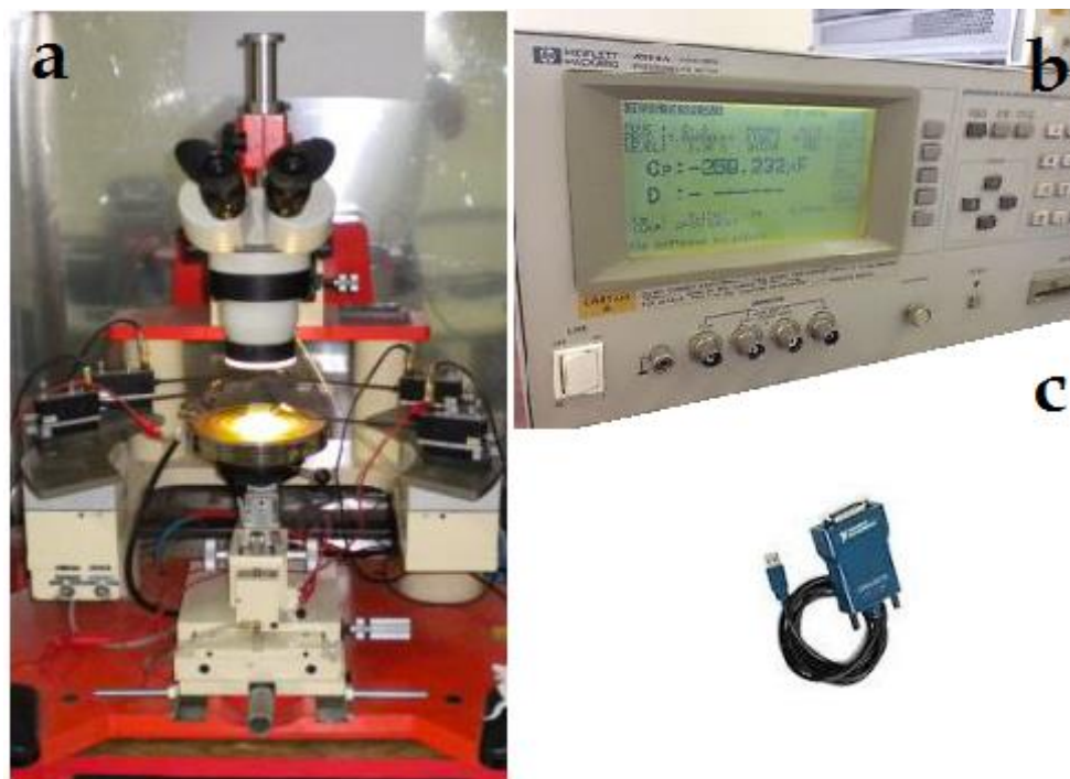
Εικόνα 15 α. Σύστημα probe του εργαστηρίου ηλεκτρικών μετρήσεων στον Τομέα Φυσικής, ΕΜΠ β. αναλυτής σύνθετης αντίστασης τύπου Agilent 4284A (pF) γ. Θύρα GPIB
