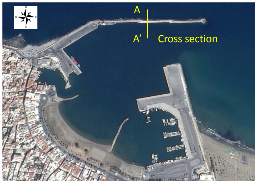
Εικόνα 5-15: Τομή A-A' προσήνεμου μόλου λιμένα όπου θα υπολογιστεί η κυματική υπερπήδηση.
