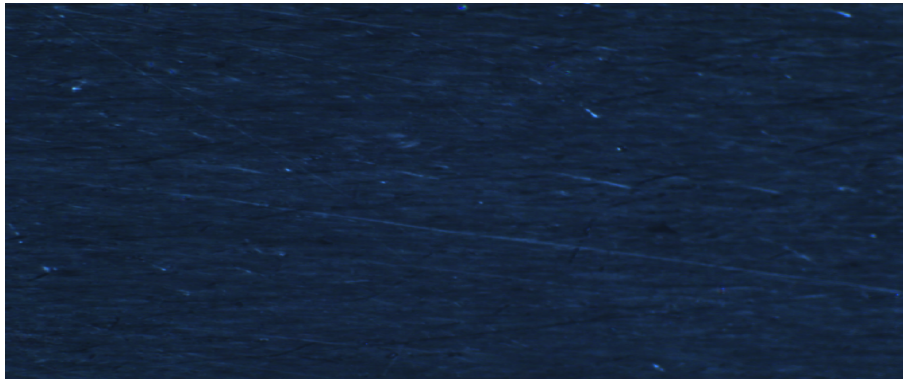
Εικόνα 2. Εικόνα πολωτικού μικροσκοπίου για την νηματική υδροκρυσταλλική φάση δείγματος 5CB
