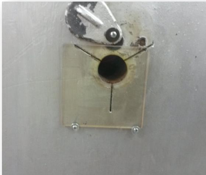
Πυρίμαχο γυαλί τοποθετημένο στη κεντρική οπή του φούρνου
