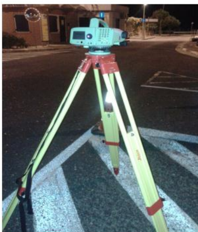
Σχήμα 36. Χωροβάτης Leica DNA03 στη θέση X1 στην παρειά προς Ελευσίνα
