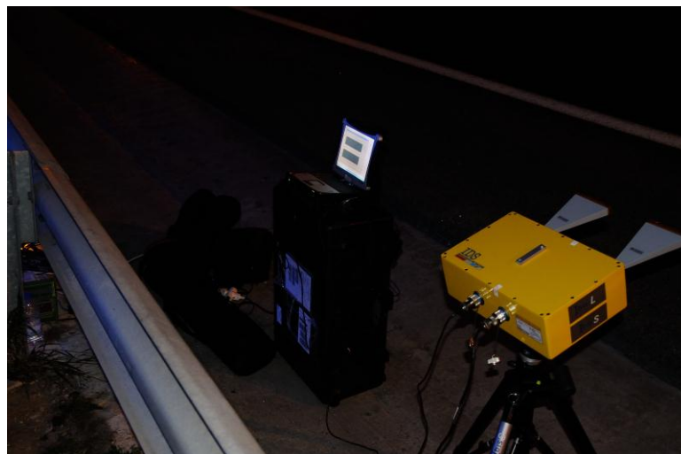
Σχήμα 39. Επίγειο radar μικροκυματικής συμβολομετρίας συνδεδεμένο με τον ηλεκτρονικό υπολογιστή.
