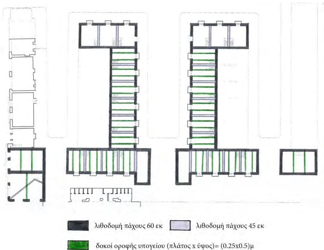
Σχήμα 3.30: Σκαρίφημα κάτοψης υπογείου. Με χρώμα διακρίνονται τα δομικά στοιχεία της κάτοψης
