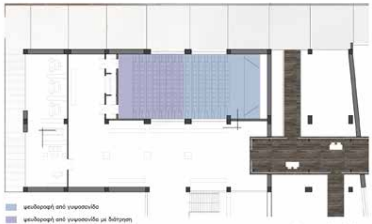
κόπηση οροφής αμφιθεάτρου κλίμακα 1:200
