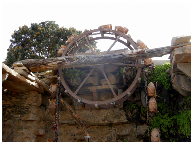
Εικόνα 3.6.2. Σχοινί με δοχεία γύρω από τον τροχό της saqiya (φωτ. Rougetete, www.flickr.com )
