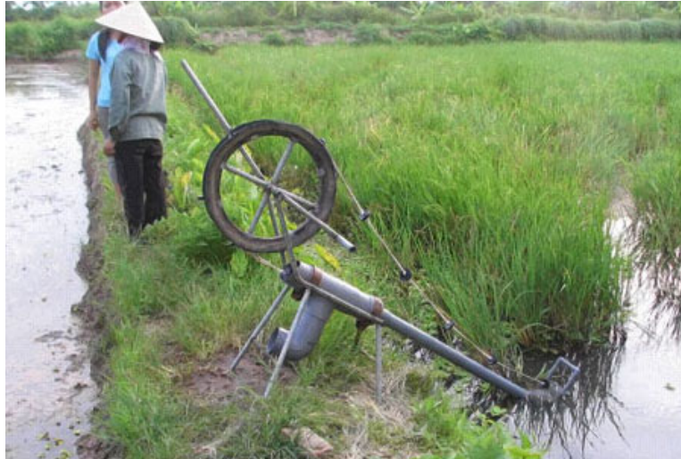
Εικόνα 5.4.5 Αντλία με σχοινί και ροδέλες (rope and washer pump) στο Βιετνάμ τον 21ο αι., (www.akvo.org)
