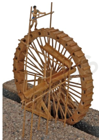
Εικόνα 2.2.4. Υποδιαιρεμένος τροχός τύπου πολυκαδίας του Φίλωνος ( www.kotsanas.com )
