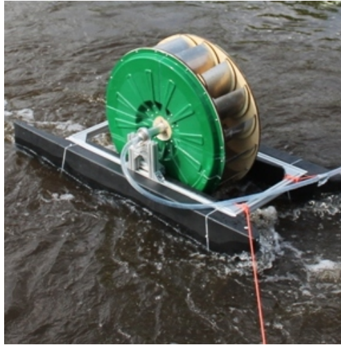
Εικόνα 5.4.9 Βιομηχανική πλωτή «νορία» (Barsha pump) στο Νεπάλ το 2014 ( www.aqysta.com )
