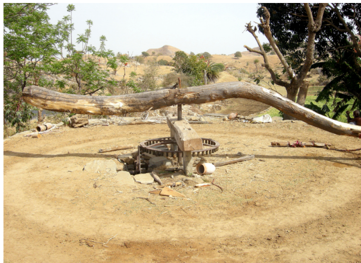
Εικόνα 3.6.3. Άποψη του χώρου κίνησης των ζώων στο μηχανισμό της saqiya (φωτ. Rougetete, www.flickr.com )
