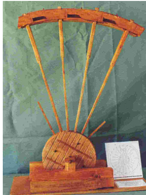
Εικόνα 3.4.3. Τμήμα τροχού τύπου πολυκαδίας (Ανακατασκευή Διονύσης Κριάρης, www.archimedesclock.gr )
