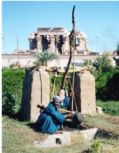
Εικόνα 5.3.1 Shaduf στην Αίγυπτο το 2001 (φωτ. Hajor, www.wikipedia.com )
