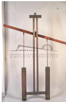
Εικόνα 2.2.2. Η καταθλιπτική αντλία του Κτησίβιου (Ανακατασκευή Διονύσης Κριάρης. Παραχώρηση του Τ.Μ.Θ.)
