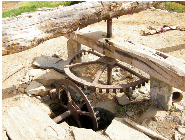
Εικόνα 3.6.1. Σύστημα γραναζιών σε ορθή γωνία σε saqiya στη σημερινή Ινδία (φωτ. Rougetete, www.flickr.com )
