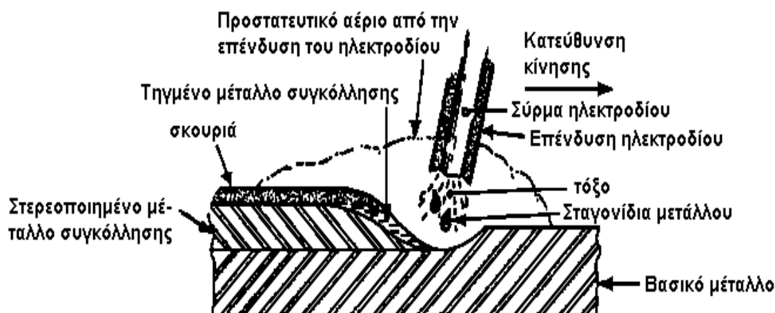
ΣΧΗΜΑ 4 : Συγκόλληση με επενδεδυμένα ηλεκτρόδια
