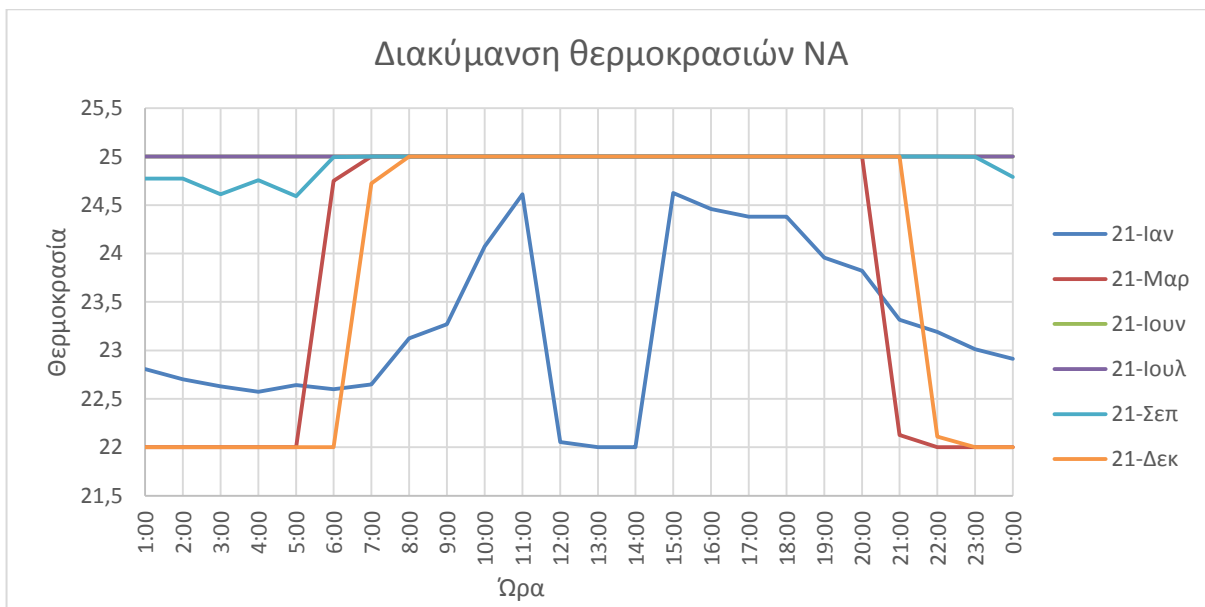
Εικ.6.4 Διακύμανση θερμοκρασιών θαλάμου βελτίωσης 1 για νοτιοανατολικό προσανατολισμό
