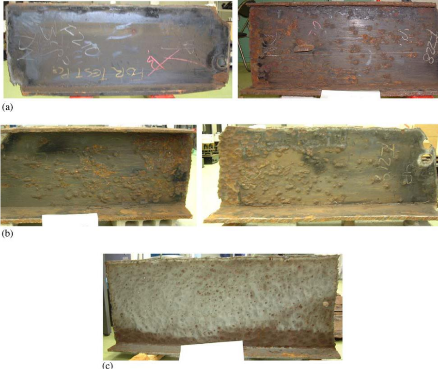
Εικόνα 13: Διάβρωση με βελονισμούς στους νομείς του κύτους φορτηγού πλοίου ηλικίας 14 ετών α) Άνω τμήμα β) Μεσαίο τμήμα γ) Κάτω τμήμα, κατόπιν αμμοβολής [46]
