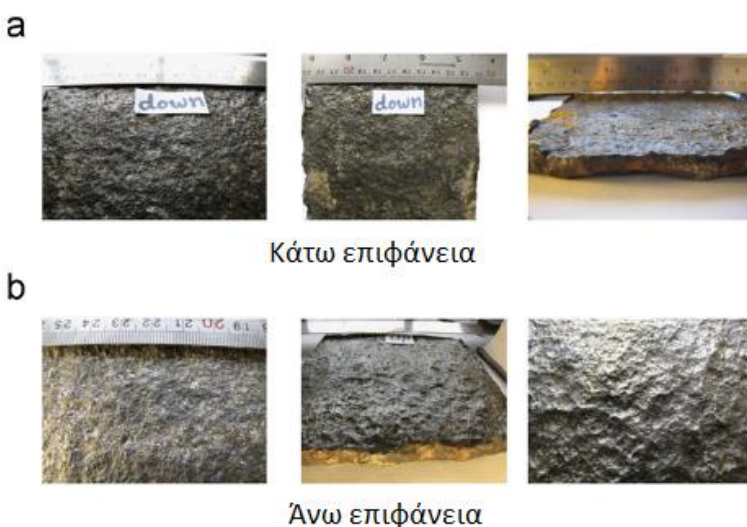
Εικόνα 11: Άποψη (α) Κάτω και (β) Άνω επιφάνειας ελάσματος που έχει υποστεί γενική διάβρωση [44]
