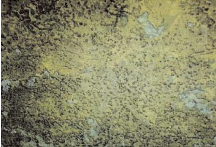
Εικόνα 27: Διάβρωση με βελονισμούς προκληθείσα σε έλασμα εσωτερικού πυθμένα κατόπιν 85 ημερών επαφής με φορτίο θείου [67]
