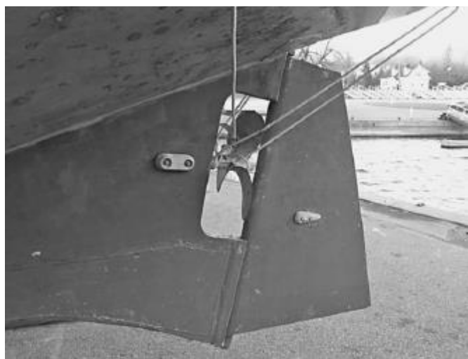
Εικόνα 2: Θυσιαζόμενα ανόδια ψευδαργύρου στην τρόπιδα και το πηδάλιο ιστιοπλοϊκού σκάφους [9]
