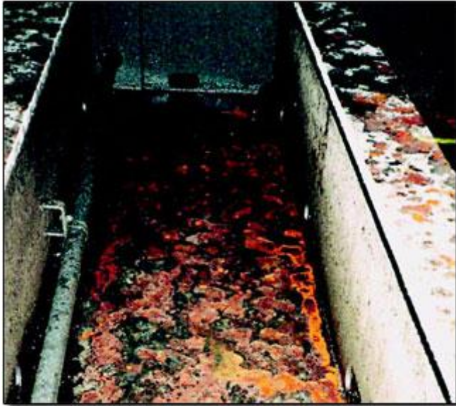
Εικόνα 16: Αποικίες βακτηρίων στον πυθμένα δεξαμενής καυσίμου [51]
