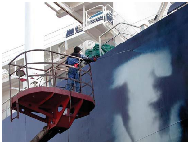
Εικόνα 7: Εφαρμογή επιστρώματος με εκνέφωση άνευ αέρος στα έξαλα ενός πλοίου [23]
