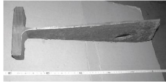
Εικόνα 12: Νομέας κύτους φορτίου bulk carrier ηλικίας 13 ετών που εμφανίζει γενική διάβρωση (δεν είχε επιστρωθεί κατά την κατασκευή του πλοίου) [45]
