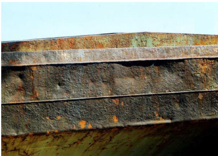
Εικόνα 20: Διάβρωση στομίων κυτών και ελασμάτων άνω πλευρικών δεξαμενών [88]
