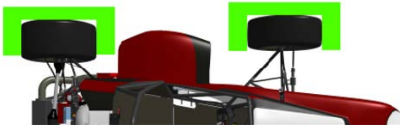
Σχήμα 2.9: Οι πράσινες επιφάνειες αντιπροσωπεύουν τους χώρους στους οποίους δεν μπορούν να εισέρχονται αεροδυναμικές συσκευές ή άλλες διαμορφώσεις.
