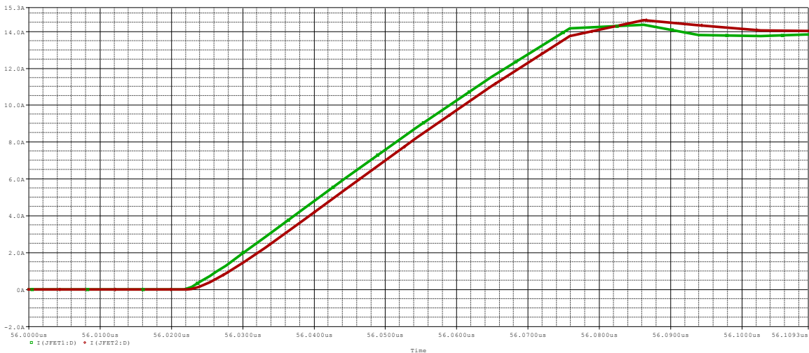
Σχήμα 8.6: Κυματομορφές ρευμάτων έναυσης των normally-off JFET1 (πράσινο χρώμα) και JFET2 (κόκκινο χρώμα) με παράσιτη αυτεπαγωγή L_{DS2}=50nH .
