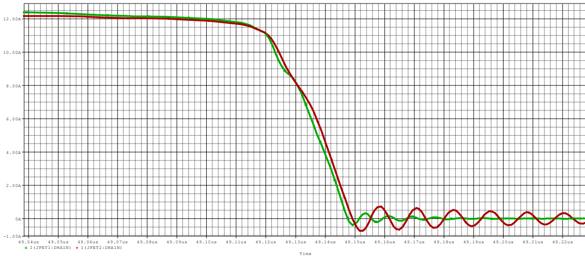
Σχήμα 8.5: Κυματομορφές ρευμάτων έναυσης των normally-on JFET1 (πράσινο χρώμα) και JFET2 (κόκκινο χρώμα) με παράσιτη αυτεπαγωγή LDS2=50nH .
