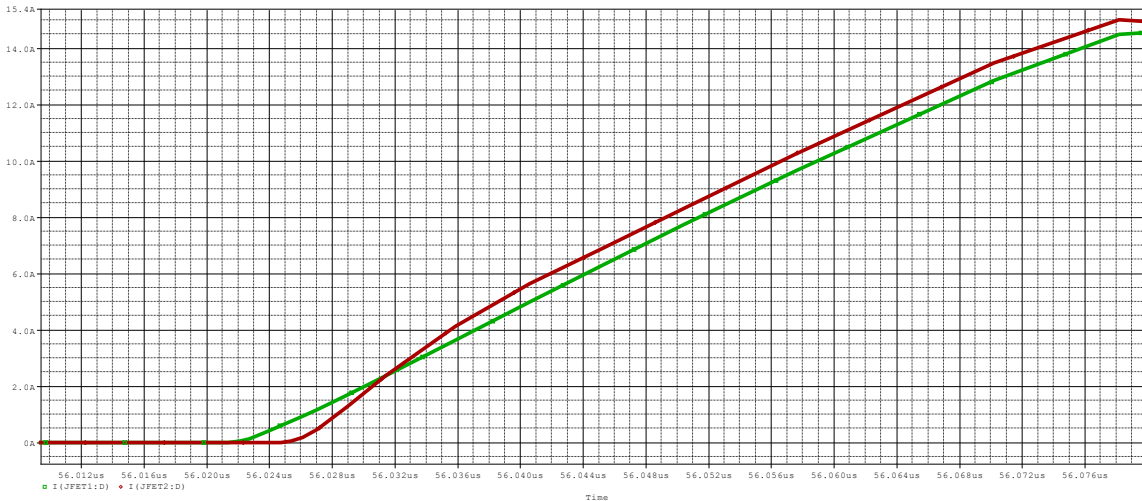
Σχήμα 8.10: Κυματομορφές ρευμάτων έναυσης των normally-off JFET1 (πράσινο χρώμα) και JFET2 (κόκκινο χρώμα) με παράσιτη αυτεπαγωγή LGS2=100nH.
