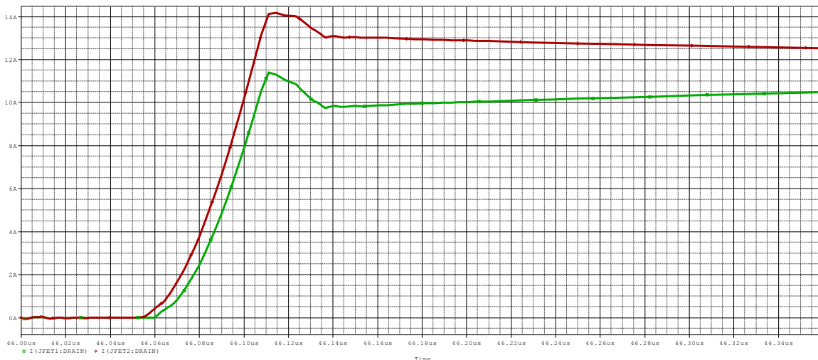
Σχήμα 8.33: Κυματομορφές έναυσης του ρεύματος JFET1 (πράσινο χρώμα), ρεύματος JFET2 (κόκκινο χρώμα) με \Delta R_G=1\Omega .
