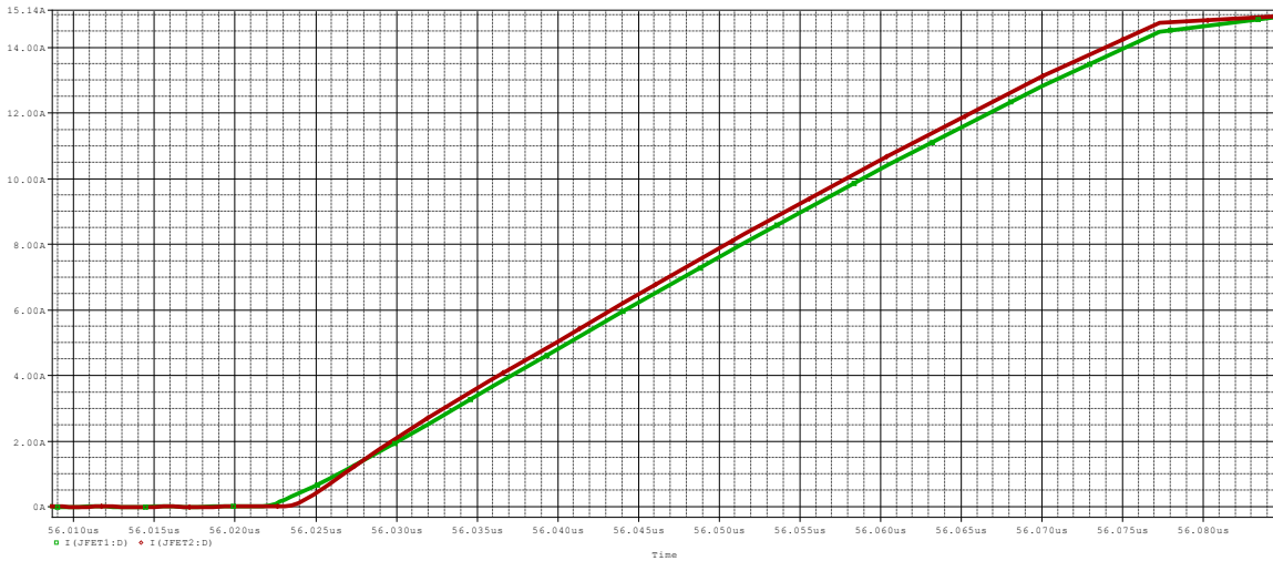
Σχήμα 8.8: Κυματομορφές ρευμάτων έναυσης των normally-off JFET1 (πράσινο χρώμα) και JFET2 (κόκκινο χρώμα) με παράσιτη αυτεπαγωγή LGS2=50nH.
