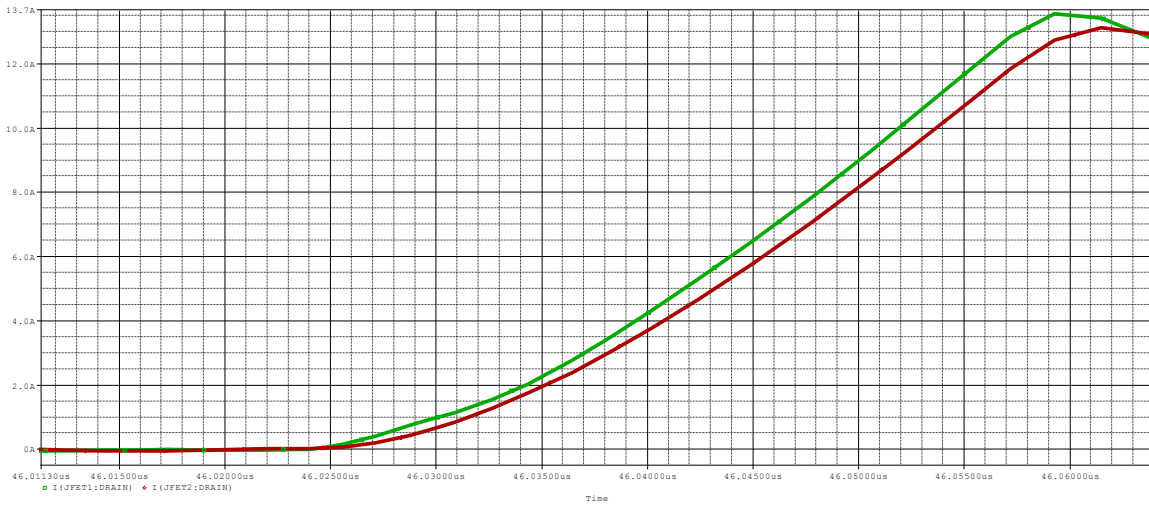
Σχήμα 8.4: Κυματομορφές ρευμάτων έναυσης των normally-on JFET1 (πράσινο χρώμα) και JFET2 (κόκκινο χρώμα) με παράσιτη αυτεπαγωγή LDS2=50nH .
