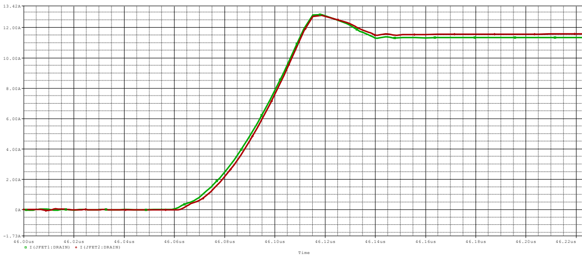
Σχήμα 8.36: Κυματομορφές έναυσης του ρεύματος JFET1 (πράσινο χρώμα), ρεύματος JFET2 (κόκκινο χρώμα) με \Delta R_G=1\Omega μετά την εξισορρόπηση ρευμάτων.
