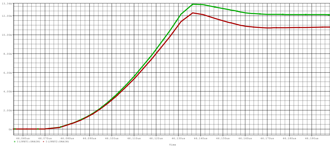
Σχήμα 8.12: Κυματομορφές ρευμάτων έναυσης των normally-on JFET1 (πράσινο χρώμα) και JFET2 (κόκκινο χρώμα) με παράσιτη αυτεπαγωγή LSS2=10nH.
