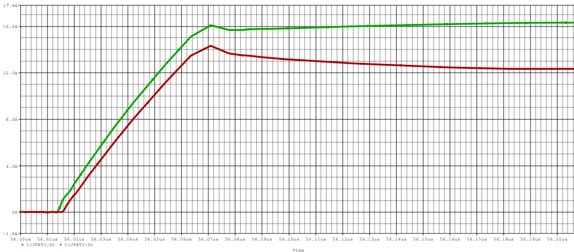
Σχήμα 8.26: Κυματομορφές έναυσης του ρεύματος JFET1 (πράσινο χρώμα), ρεύματος JFET2 (κόκκινο χρώμα) με \Delta R_G=2\Omega .
