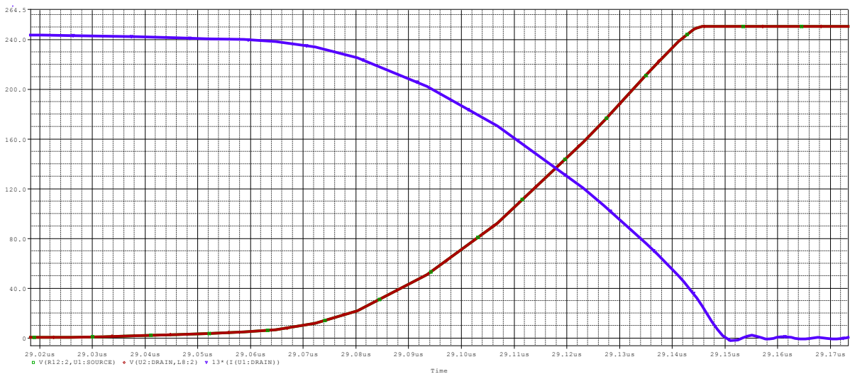
Σχήμα 8.57: Κυματομορφές σβέσης τάσης JFET1 (πράσινο χρώμα), τάσης JFET2 (κόκκινο χρώμα) και ρεύματος τους (μωβ χρώμα) για ίδιες παράσιτες αυτεπαγωγές των JFETs.
