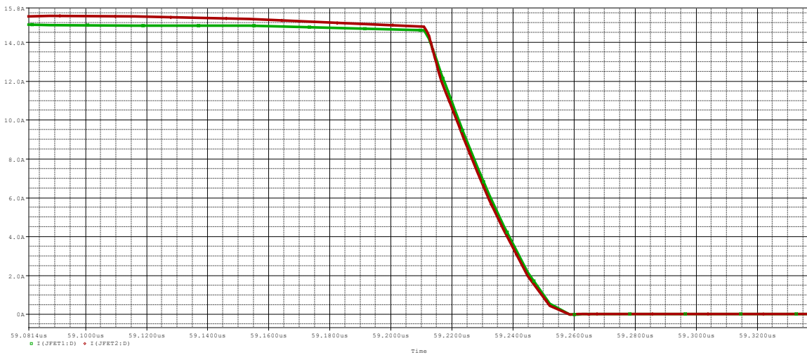
Σχήμα 8.9: Κυματομορφές ρευμάτων σβέσης των normally-off JFET1 (πράσινο χρώμα) και JFET2 (κόκκινο χρώμα) με παράσιτη αυτεπαγωγή LGS2=50nH.
