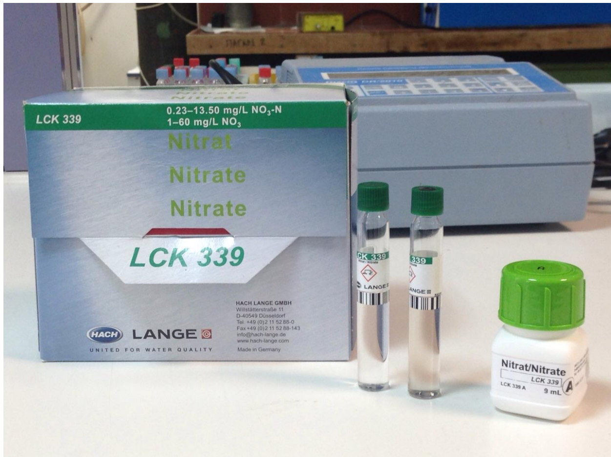
Εικόνα 48: Φιαλίδια της εταιρίας Hach Lange με κωδικό LCK 313, που χρησιμοποιούνται για τον προσδιορισμό της συγκέντρωσης νιτρικών ιόντων, με αντίστοιχο εύρος τιμών από 0,23 έως 13,5 mg/l.
