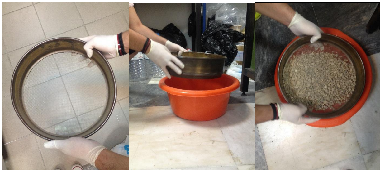
Εικόνα 18 : Το κόσκινό διαμέτρου 2mm και η διαδικασία της κοσκίνησης
