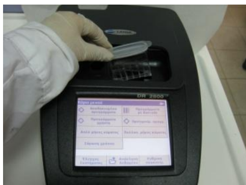
Εικόνα 46: Τοποθέτηση της κυψελίδας με περιεχόμενο δείγμα, στο φασματοφωτόμετρο
