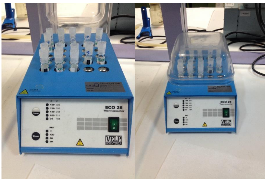
Εικόνα 42: Συσκευή όπου τοποθετείται το αντιδραστήριο για μια ώρα στους 100 βαθμούς κελσίου
