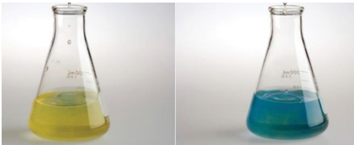
Εικόνα 50: Η απόχρωση του διαλύματος (υποκίτρινη) όταν περιέχει τα αντιδραστήρια που χρησιμοποιούνται στη μέθοδο του ασκορβικού οξέος (αριστερά) και η απόχρωση του διαλύματος (μπλε) όταν έρθουν σε επαφή με τον P (δεξιά) (Averill and Eldredge, 2005).
