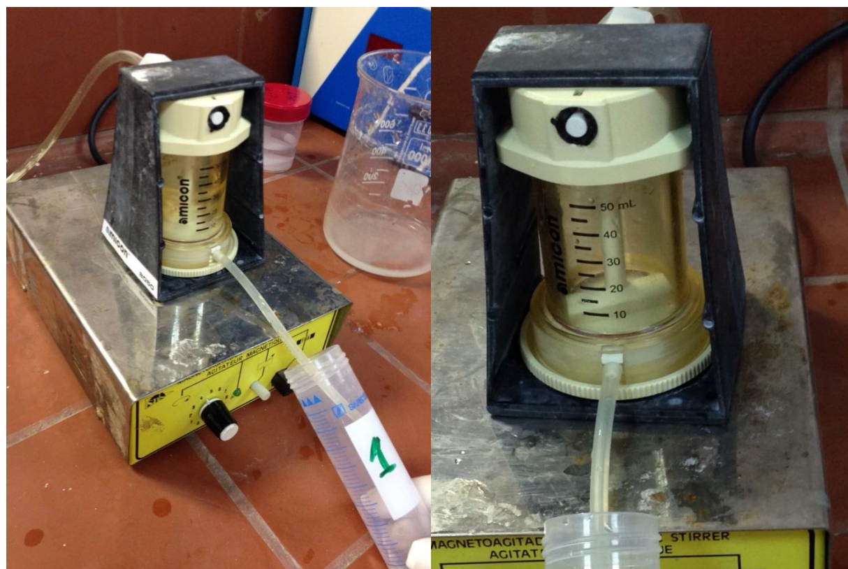
Εικόνα 28: Συσκευή κλασματοποίησης για μεμβράνες 30 kDa και 1kDa
