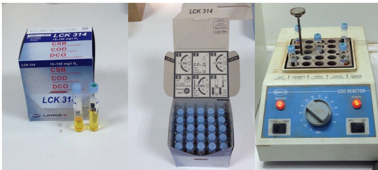
Εικόνα 47: Φιαλίδια της εταιρίας Hach Lange με κωδικό LCK 314, που χρησιμοποιούνταν για τον προσδιορισμό της συγκέντρωσης διαλυτού COD, με αντίστοιχο εύρος τιμών από 15 έως 150 mg/l.
