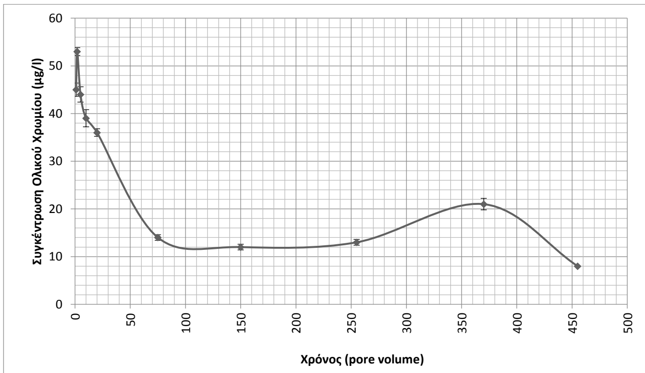
Διάγραμμα 62: Μετρήσεις Ολικού Χρωμίου σε \mu\text{g/l} για την περίπτωση του πειράματος 4 στηλών εν σειρά με νερό με εξασθενές χρώμιο 40 \mu\text{g/l}
