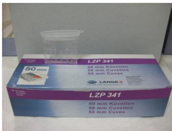
Εικόνα 38: Απεικόνιση των πλαστικών κυψελίδων που χρησιμοποιούνται για το φασματοφωτομετρικό προσδιορισμό Cr(VI) των δειγμάτων.
