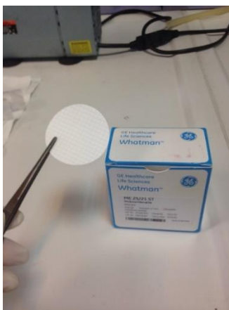
Εικόνα 41: Απεικόνιση μεμβράνης με διάμετρο πόρων 0,45 \mu\text{m} , που χρησιμοποιούνταν για τη διήθηση των δειγμάτων.
