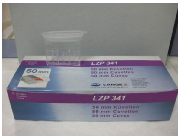
Εικόνα 45: Απεικόνιση των πλαστικών κυψελίδων που χρησιμοποιούνται για το φασματοφωτομετρικό προσδιορισμό Cr(VI) των δειγμάτων.
