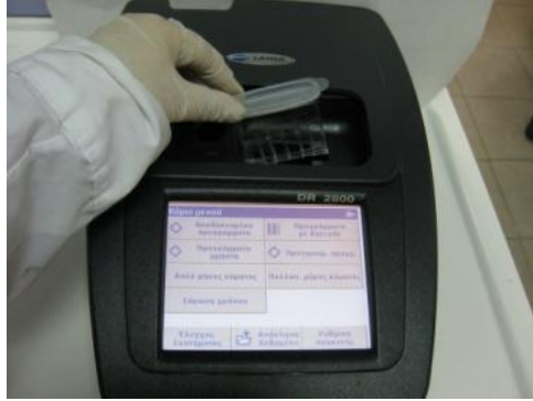
Εικόνα 39: Τοποθέτηση της κυψελίδας με περιεχόμενο δείγμα, στο φασματοφωτόμετρο.
