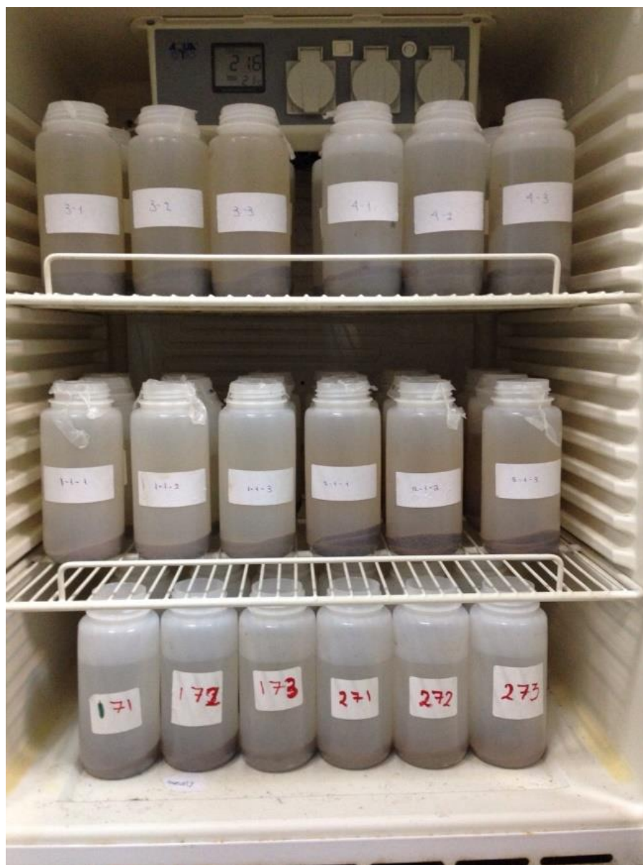
Εικόνα 24: Τοποθέτηση των πλαστικών δοχείων στον επωαστήρα για τον έλεγχο της θερμοκρασίας
