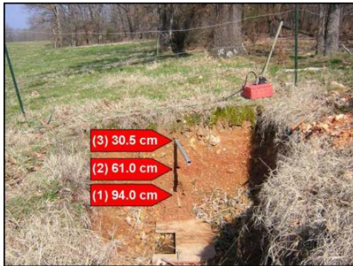
Εικόνα 1.26. Ενδεικτικό τεστ μέτρησης της ταχύτητας στο γεωραντάρ. Μία μεταλλική ράβδος εισάγεται στο έδαφος σε τρία διαφορετικά βάθη 1, 2, 3 (αριστερά) και η ανάκλαση του σήματος πάνω στη ράβδο σε κάθε βάθος δίνει τις αντίστοιχες ανωμαλίες (δεξιά).
