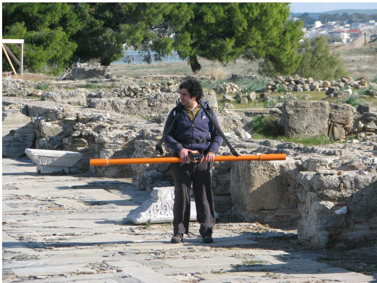
Εικόνα 3.8. Διαδικασία λήψης των ηλεκτρομαγνητικών μετρήσεων στο δάπεδο της Βασιλικής με το όργανο GF CMD-2.
