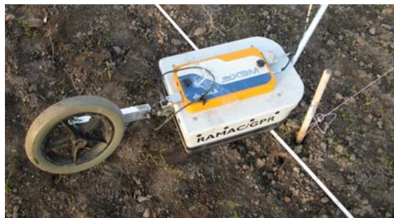
Εικόνα 3.14. Διάταξη GPR της MALA Geoscience με θωρακισμένη κεραία 250 MHz. Πηγή: http://www.archeores.com .
