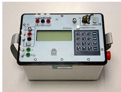
Εικόνα 1.10. Όργανο μέτρησης της ηλεκτρικής αντίστασης (πηγή www.geomatrix.co.uk )
