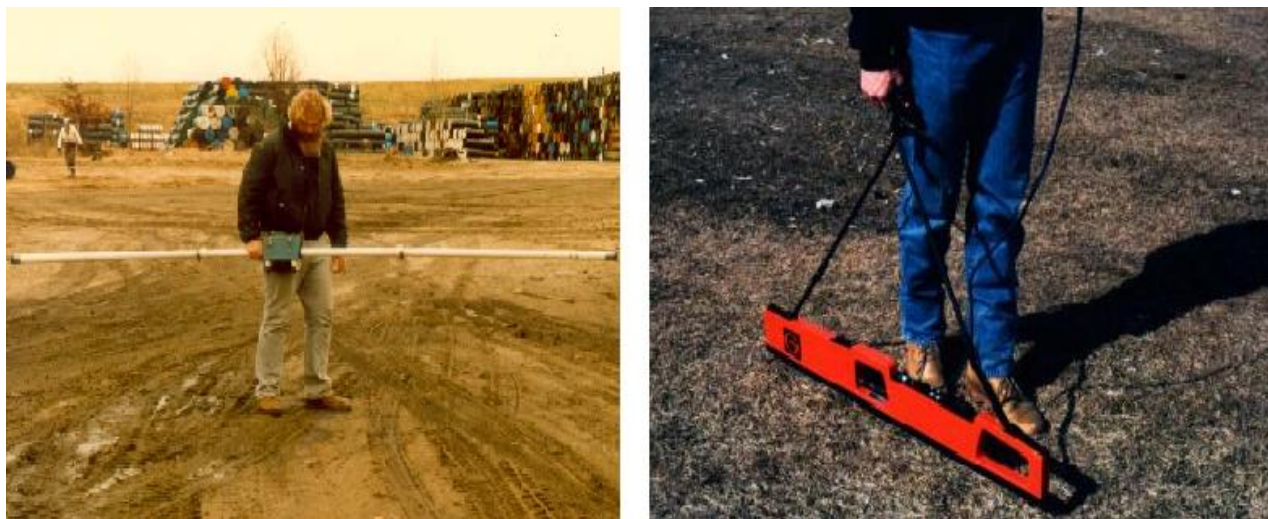
Εικόνα 1.18. Ευρέως χρησιμοποιούμενα όργανα ηλεκτρομαγνητικής μεθόδου. EM-31 (αριστερά) και EM-38 (δεξιά), (πηγή http://geonicsrental.com/ , http://www.cflhd.gov )
