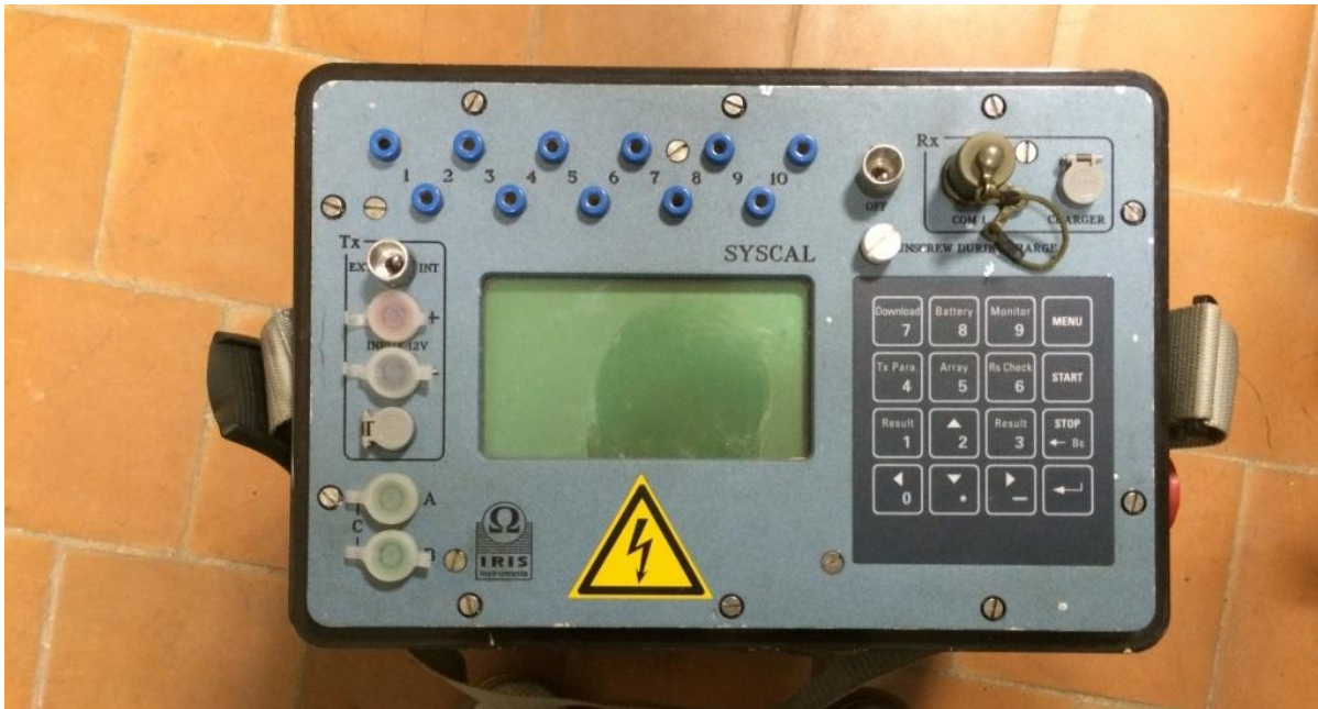
Εικόνα 3.18. Το όργανο μέτρησης των τιμών ειδικής αντίστασης, SYSCAL Pro. Πηγή: http://www.gubkin.ru/
