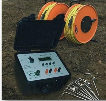
Εικόνα 1.11. Εξοπλισμός υπαίθρου για τον προσδιορισμό της φαινόμενης ειδικής αντίστασης, \rho_w , που περιλαμβάνει το όργανο μέτρησης, τα καρούλια με τα καλώδια και τα ηλεκτρόδια. (πηγή http://uavsurvey.ca/Ohmega.htm )
