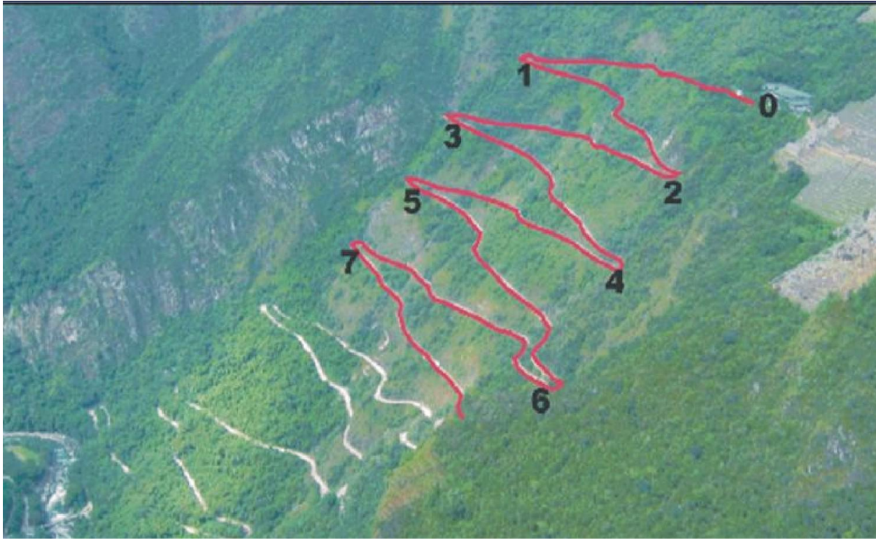
Εικόνα 1.30. Με κόκκινο χρώμα απεικονίζονται οι γραμμές στις οποίες πραγματοποιήθηκαν οι έρευνες. Μέθοδος ηλεκτρικής αντίστασης (γραμμές 0 έως 7) και ηλεκτρομαγνητική μέθοδος (γραμμές 0, 1, 2).
