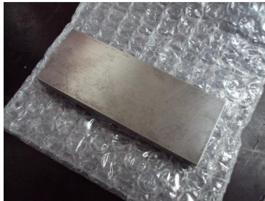
Σχήμα 3.1.1 – Πλακίδιο Johansson γνωστής επιτεδότητας.
