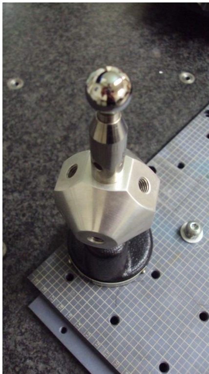
Σχήμα 4.1.3 – Πρότυπη σφαίρα μηχανής μέτρησης συντεταγμένων MISTRAL-070705.
