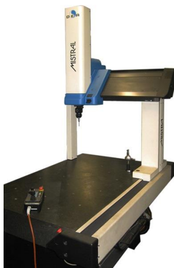
Σχήμα 3.1 – Μηχανή μέτρησης συντεταγμένων MISTRAL-070705.
