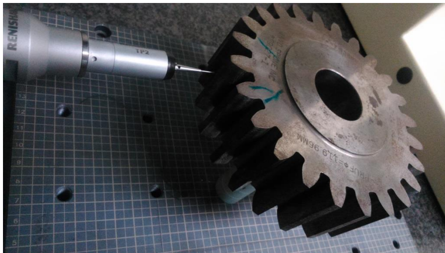
Σχήμα 4.2.1 – Πρότυπος οδοντωτός τροχός 24 οδόντων.
