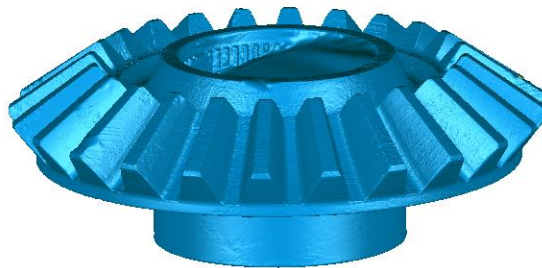
Σχήμα 5.1.2 – Μοντέλο πολυγώνων κωνικού οδοντωτού τροχού.
