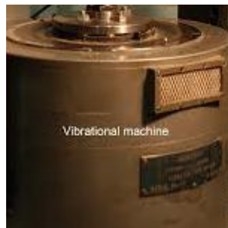
Εικόνα 43: Δονητική τράπεζα DERRITRON (Εργαστήριο Στοιχείων Μηχανών ΕΜΠ)
