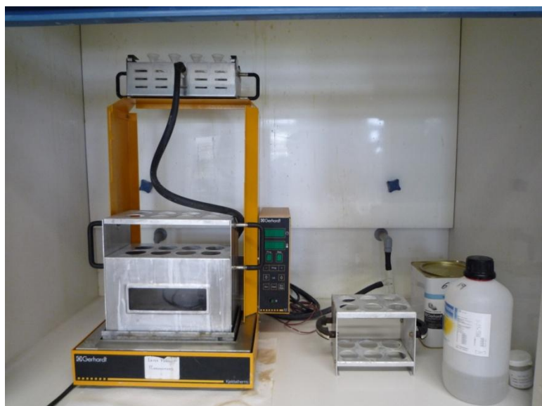
Εικόνα 27: Συσκευή χώνευσης Gerhard Kjeldatherm KB / KBL
