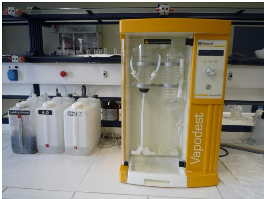
Εικόνα 28: Συσκευή απόσταξης Gerhard Vapodest 30s
