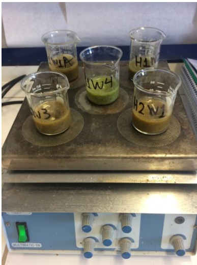
Εικόνα 20: Η συσκευή ανάδευσης τύπου Selecta / Multomatic
