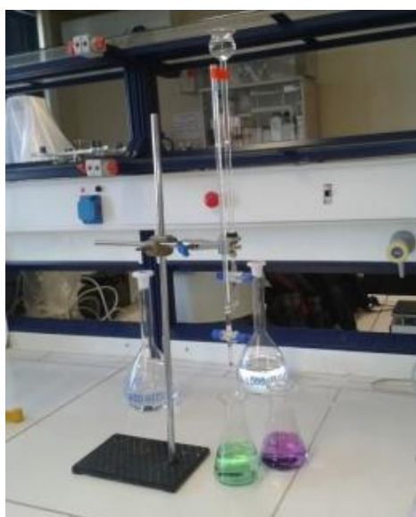
Εικόνα 29: Τιτλοδότηση για τον προσδιορισμό του ολικού αζώτου
