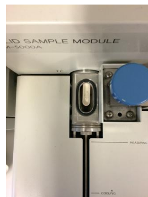
Εικόνα 26: Εισαγωγή δείγματος στο φούρνο καύσης
