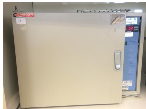
Εικόνα 22: Φούρνος ξήρανσης του οίκου Carbolite AX30
