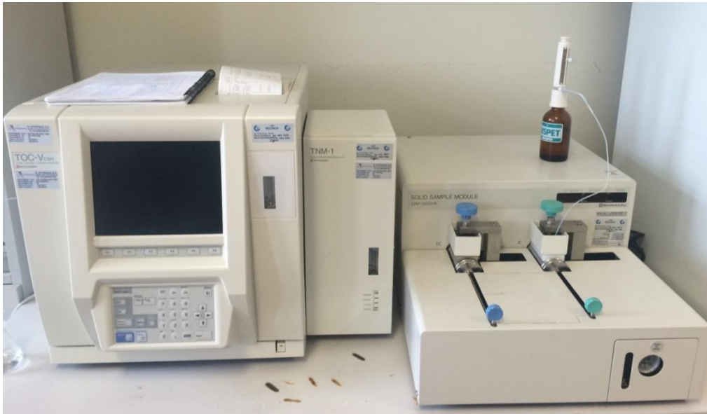
Εικόνα 24: Αναλυτής του οίκου Shimadzu TOC-V CSH
