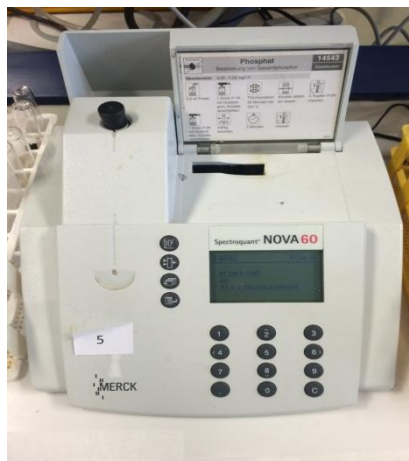
Εικόνα 33: Φασματοφωτόμετρο NOVA60 της MERCK
