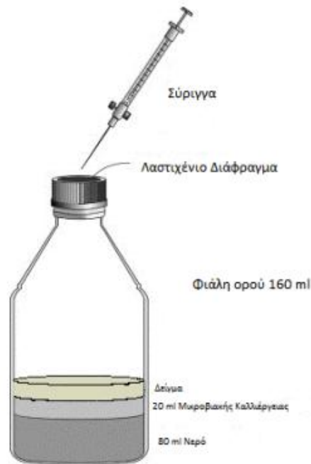
Εικόνα 34: Φιαλίδια διεξαγωγής BMP δοκιμών (Σιάμαρης, 2012)
