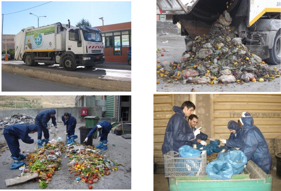
Εικόνα 9: Φωτογραφικό υλικό από τη διεξαγωγή της ανάλυσης σύστασης βιοαποβλήτων από την ομάδα της Μονάδας Περιβαλλοντικής Επιστήμης και τεχνολογίας (Malamis et al., 2014)
