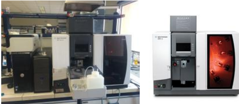
Εικόνα 32: Φασματοφωτόμετρο ατομικής απορρόφησης Agilent AA240FS
