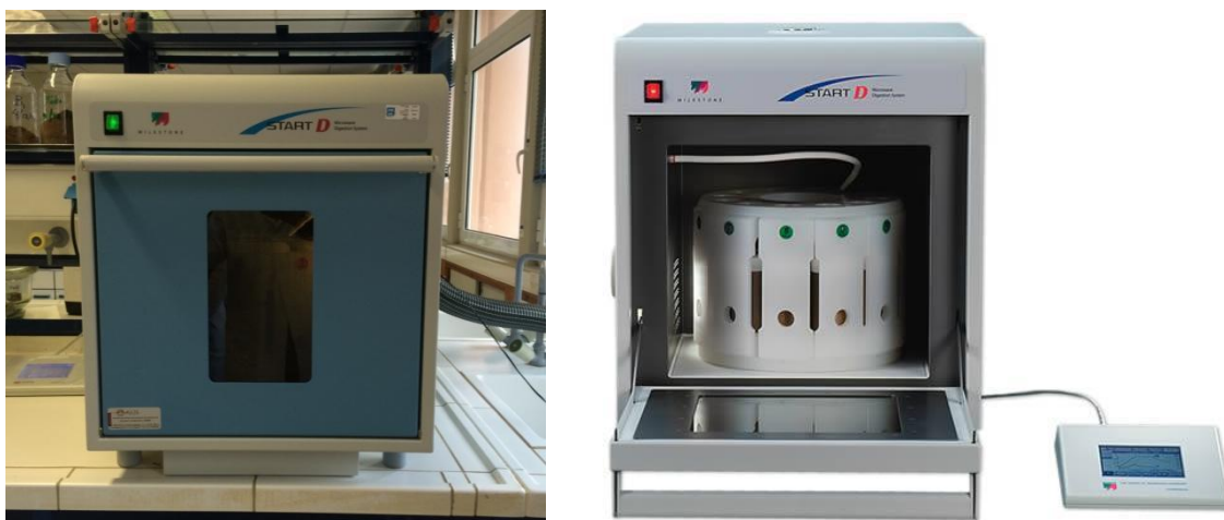
Εικόνα 30: Φούρνος μικροκυμάτων Milestone Start D με ATC CE 400 Temperature Sensor
