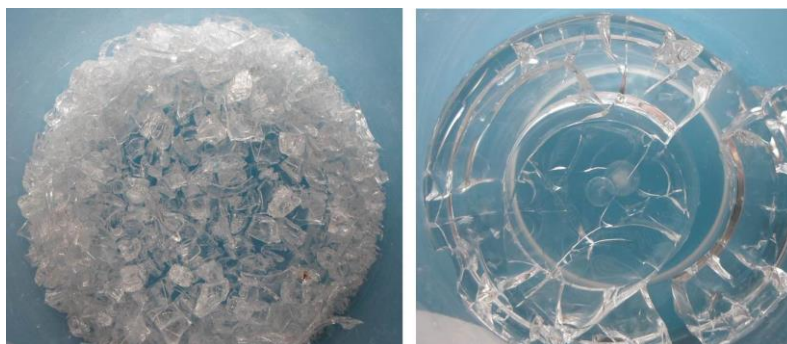
Εικόνα 3.1. Το φαινόμενο της ρηγμάτωσης πυριτικών στερεωτικών υλικών. Εργαστηριακά παρασκευασμένη σύνθεση TEOS /αιθανόλη/ DBTL
