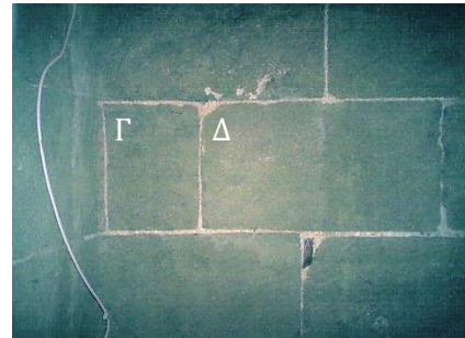
Εικ.9.8β. Γκρίζος πωρόλιθος Η τοιχοποιία μετά το πέρας 3 μηνών από την εφαρμογή (Γ)B005, (Δ)PMC1:1
