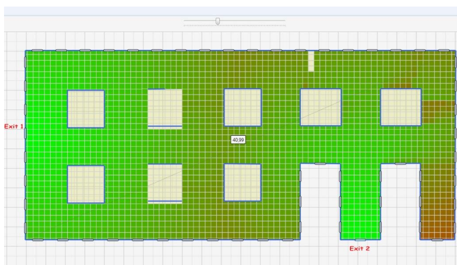
Σχήμα 9.10 "Χαρτογράφηση" αποτελεσματικότητας εκκένωσης χώρου των υφιστάμενων θέσεων εξόδων του υπόγειου χώρου του Τ.Π.Α. με το Exit Locator
