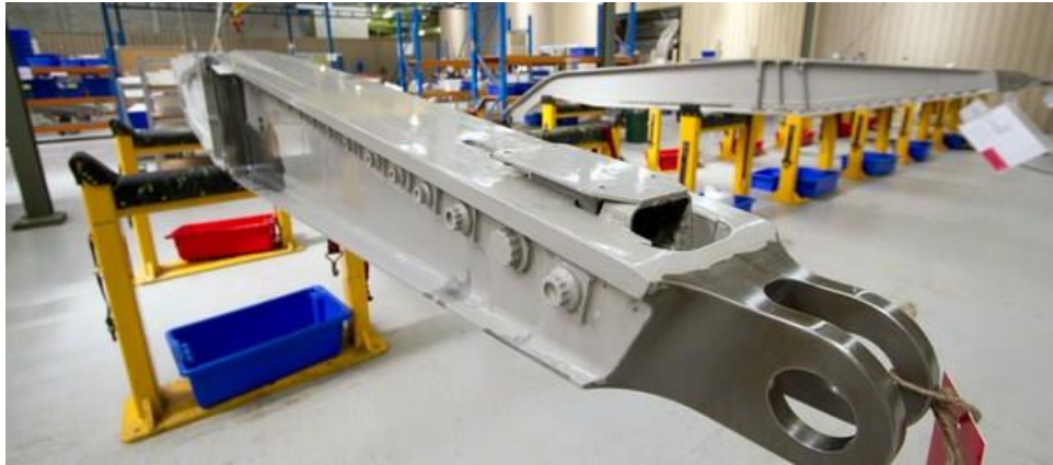
Εικόνα 5.11. Η επιφάνεια κύλισης των flaps (άνω επιφάνεια του flap στην εικόνα)
