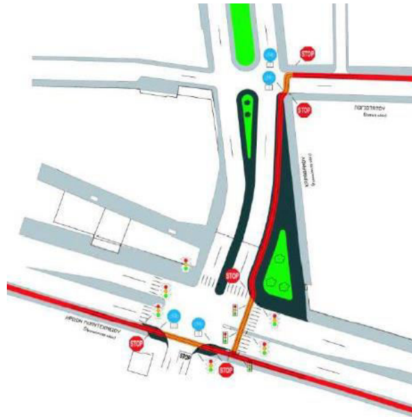
Εικόνα 5.21. Τυπική διατομή διάβασης ποδηλάτων στη διασταύρωση Ηρ. Πολυτεχνείου με Καραθάνου
