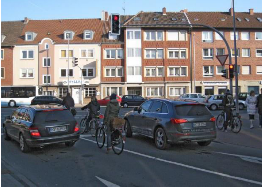
Εικόνα 4.19. Κοινός φωτεινός σηματοδότης για ποδηλάτες και κυκλοφορία μηχανοκίνητων οχημάτων - Τύπος 2 (Πηγή: VEP, Münster, 2025)
