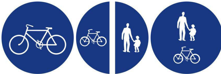
Εικόνα 3.4. (α) P-54: Οδός υποχρεωτικής διέλευσης ποδηλάτων (μ) P-65: Η κάθε κατηγορία χρηστών πρέπει να χρησιμοποιεί την πλευρά του αντίστοιχου διαδρόμου (δ) P-66: Οι κατηγορίες χρηστών που απεικονίζονται επιτρέπεται να χρησιμοποιούν ταυτόχρονα τον ειδικό διάδρομο. (Πηγή: Ελληνικός Κ.Ο.Κ.)
