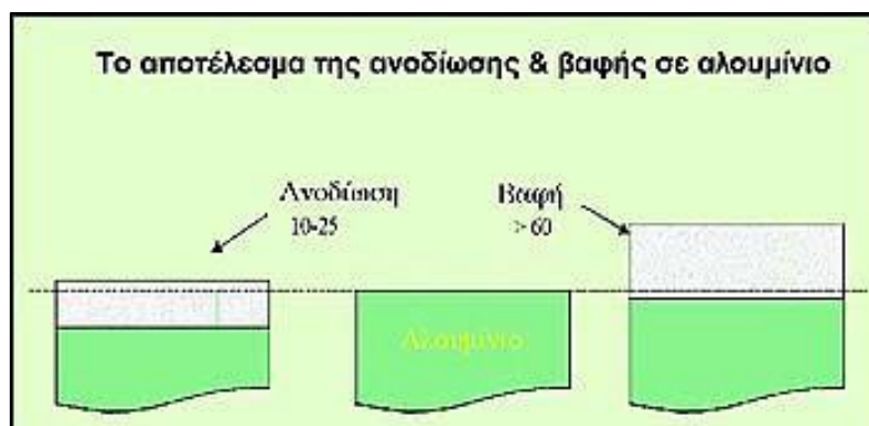
Εικόνα 4.4: Τελικό αποτέλεσμα των διαδικασιών ανοδίωσης και ηλεκτροστατικής βαφής του αλουμινίου με τα αντίστοιχα πάχη τους (Τεχνική Βιβλιοθήκη 2004)
