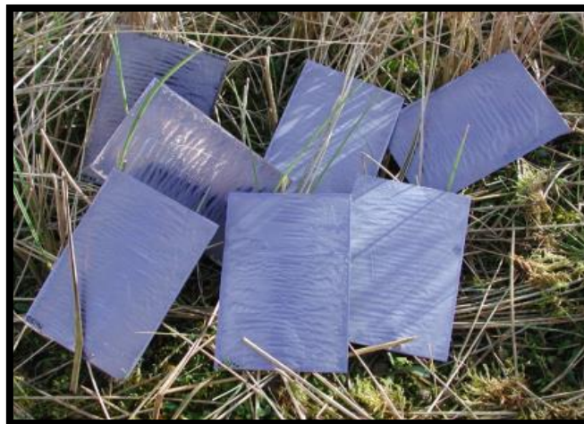
Εικόνα 3.11: Ηλιακά κελιά ταινίας πυριτίου Πηγή: Dutch Solar R&D Seminar 2006 [39]
