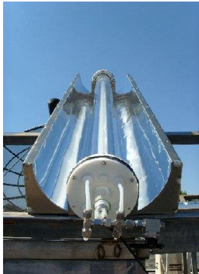
Σχήμα 2.16. Συλλέκτης τύπου CPC.[13]
