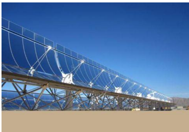
Σχήμα 2.10. Παραβολικά ηλιακά κοίλα.[10]
