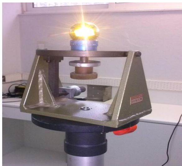
Εικόνα 6.5: Ο στόχος CCR 1.5in τοποθετημένος πάνω στη βάση του
