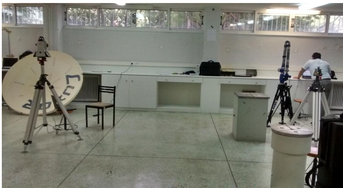
Εικόνα 7.3: Διάταξη γεωδαιτικού σταθμού, αρθρωτού βραχίονα και πρίσματος CCR για την πρώτη θέση του βραχίονα
