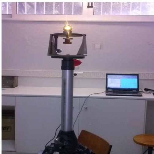
Εικόνα 7.2: Το πρίσμα CCR τοποθετημένο στη θέση παρατήρησης
