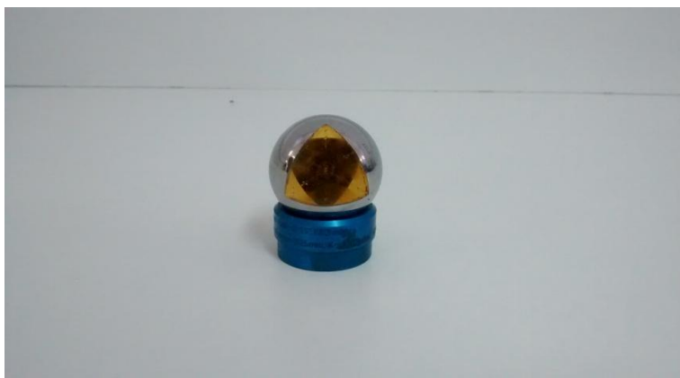
Εικόνα 6.3: Ο στόχος CCR 1.5in τοποθετημένος πάνω στη βάση του
