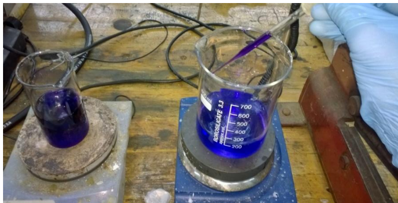
Εικόνα 2.1: Υγρή χημική μέθοδος παρασκευής συνθέτου με οξειδίο του χαλκού
