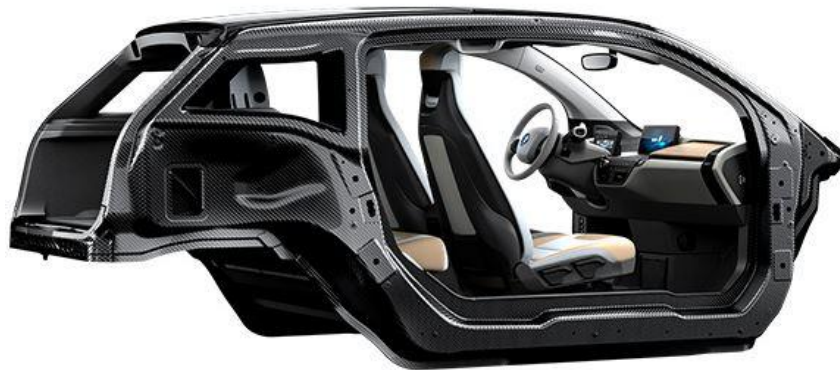
Εικόνα 1.4: Κλωβός επιβατών της BMWi3 κατασκευασμένος εξ ολοκλήρου από ανθρακονήματα
