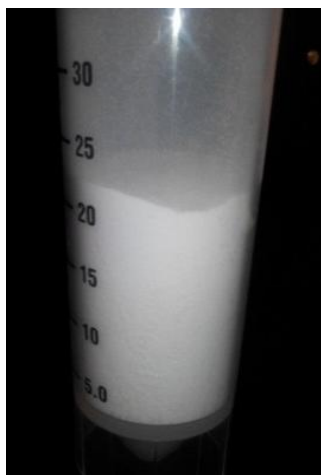
Εικόνα 2.5: Τελική νανοσκόνη μετά από ξήρανση
