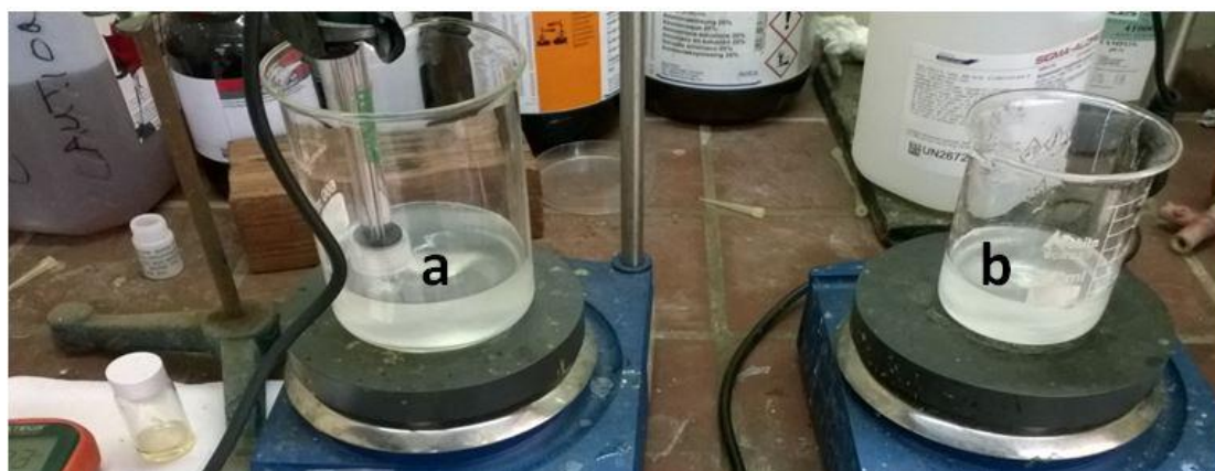
Εικόνα 2.4: Πειραματική διαδικασία παρασκευής νανοκόνεων. Αριστερό ποτήρι ζέσεως (a) – διάλυμα \text{Al}(\text{NO}_3)_3 \cdot 9\text{H}_2\text{O} , δεξί ποτήρι ζέσεως (b) – διάλυμα PEI
