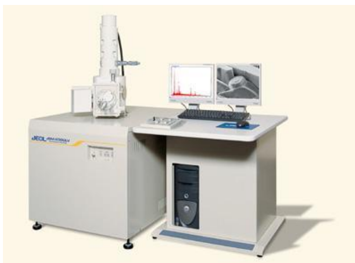
Εικόνα 2.7: Το μικροσκόπιο JEOL JSM-6380LV το οποίο χρησιμοποιήθηκε
