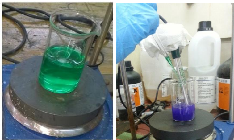
Εικόνα 2.2: Υγρή χημική μέθοδος παρασκευής σύνθετου με οξειδίου του νικελίου
