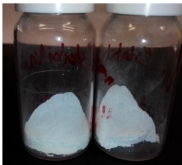
Εικόνα 2.6: Τελικές σύνθετες νανοσκόνες με εγκλείσματα οξειδίου του νικελίου και οξειδίου του χαλκού κατά αντίστοιχη σειρά
