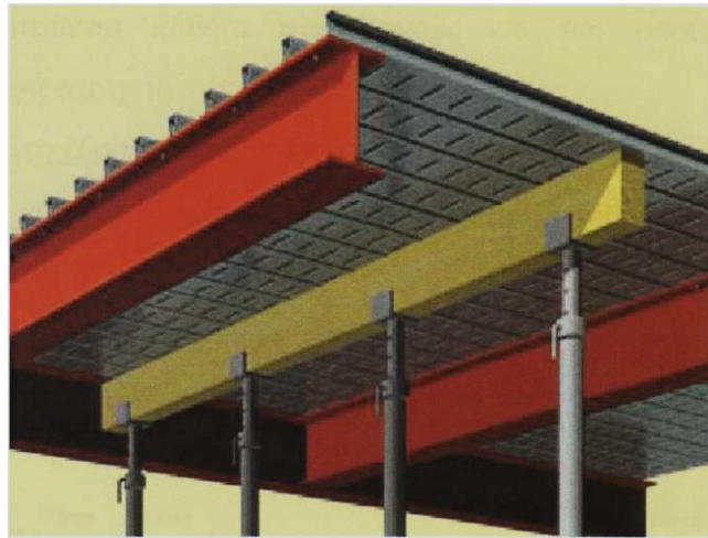
Σχήμα 1.5 Παράδειγμα προσωρινής υποστήριξης χαλυβδόφυλλου στη φάση κατασκευής
