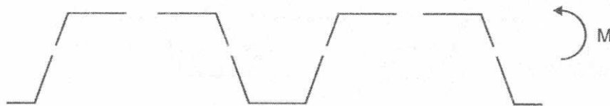
Σχήμα 1.7 : Ενεργός διατομή χαλυβδόφυλλων
