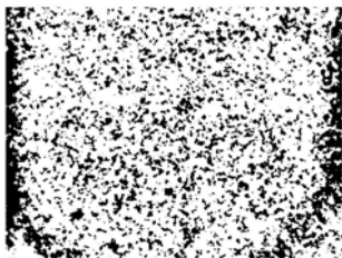
V.α. Εφαρμογή κατωφλίωσης (τιμής 80) σε Ψηφιακή εικόνα αποτέλεσμα μετά την προσαρμογή του ιστογράμματος και την εφαρμογή του φίλτρου
