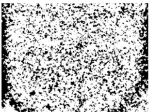
VI.α. Απομάκρυνση θορύβου, δημιουργία τελικής ψηφιακής εικόνας (threshold 80) προς μέτρηση μορφολογικών χαρακτηριστικών
