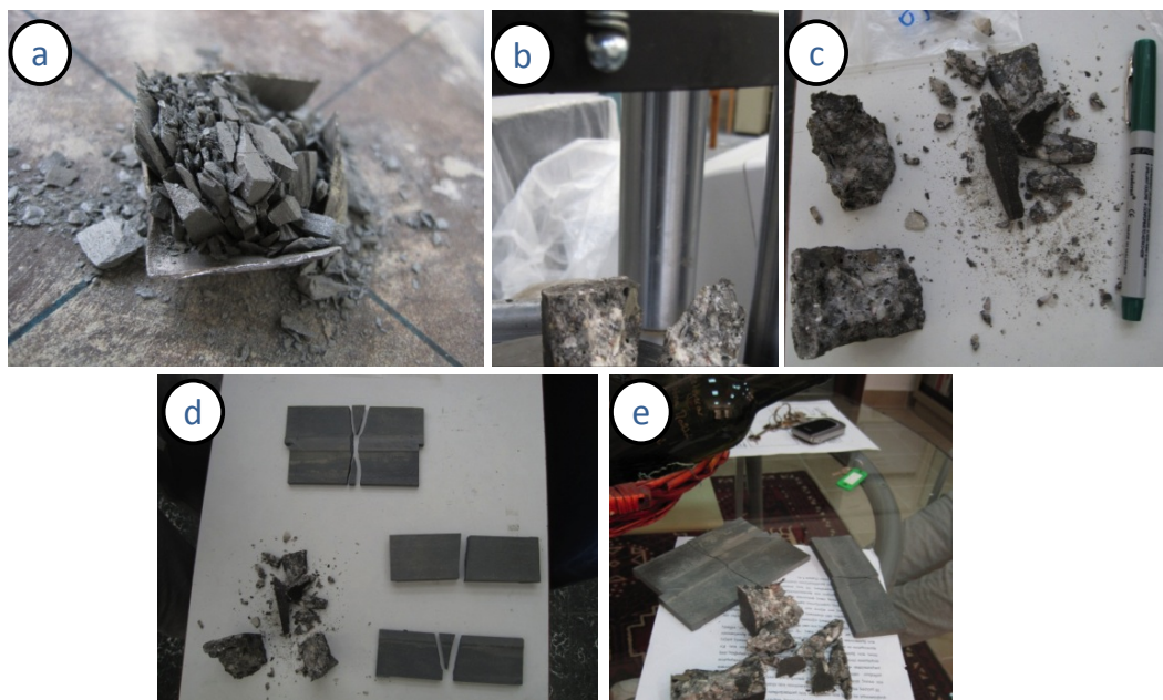
Σχήμα 6-40: Δοκίμια μετά τα πειράματα: a, b, c) Δοκίμια απλής μονοαξονικής θλίψης, d, e) Δοκίμια κάμψης τριών σημείων
