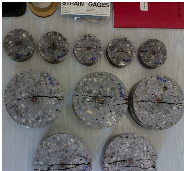
Σχήμα 6-39: Δοκίμια μετά από τις δοκιμές Βραζιλιανού δίσκου
