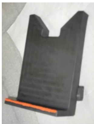
Σχήμα 4-14: Μονολιθικά τμήματα από SiC της Περίπτωσης Α
