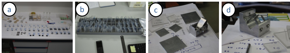
Σχήμα 6-9: a, b) Δείγματα και δειγματοφορέας πριν από τα πειράματα ακτινοβολήσεων, c, d) Σύνθετος δειγματοφορέας για τη συναρμολόγηση της πειραματικής διάταξης
