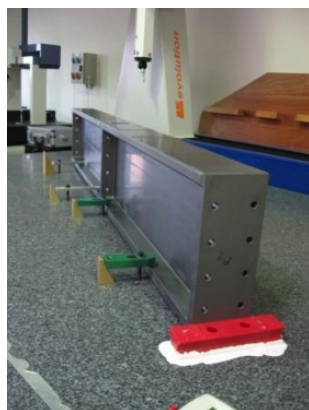
Σχήμα 4-14: Μονολιθικά τμήματα από SiC της Περίπτωσης Α
