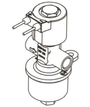
Σχήμα 2.7 Ηλεκτρική βαλβίδα υπερχείλισης καυσίμου
