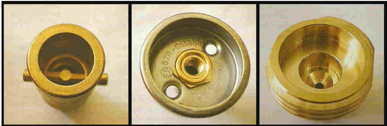
Σχήμα 2.3 Στόμια πλήρωσης: Γερμανικού (Ολλανδικού) τύπου - Ιταλικού τύπου- Γαλλικού τύπου
