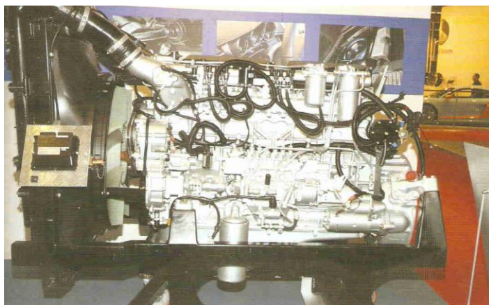
Σχήμα 6.1 Κινητήρας διπλού καυσίμου LPG-Πετρελαίου
