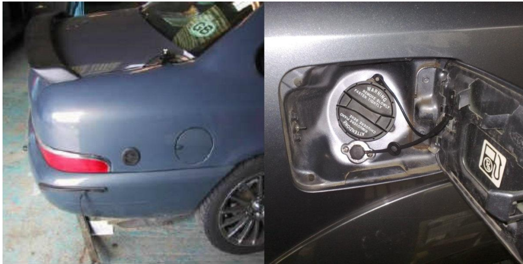
Σχήμα 2.4 Στόμιο πλήρωσης α) στο πίσω φτερό και β)δίπλα στο στόμιο της βενζίνη
