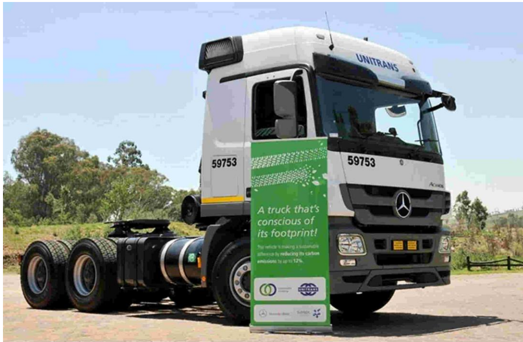
Σχήμα 6.2 Φορτηγό διπλού καυσίμου Πετρελαίου – LPG
