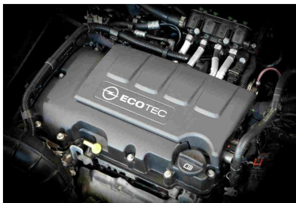
Σχήμα 3.1 Κινητήρας Opel 1.4 LPG Turbo ecoFLEX 140 ίππων
