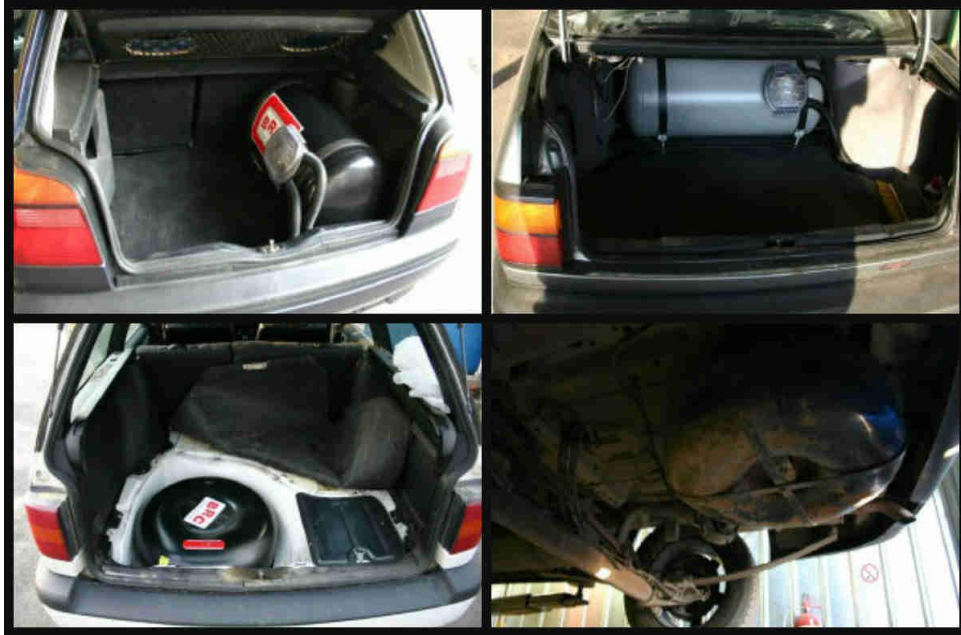
Σχήμα 4.3 Πάνω κυλινδρικές δεξαμενές που μειώνουν το χώρο αποσκευών – Κάτω δεξαμενές που καταργούν τον τροχό ανάγκης (ρεζέρβα)
