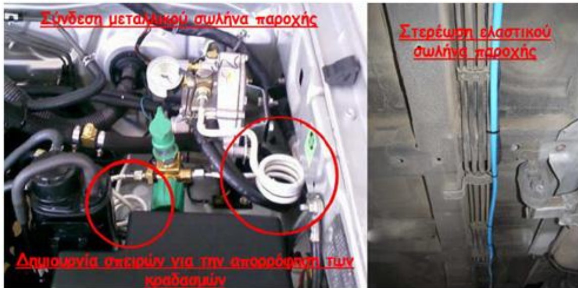
Σχήμα 2.9 Συνδέσεις και στερέωση α)μεταλλικού και β)ελαστικού σωλήνα παροχής LPG
