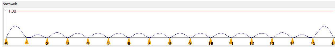
Σχήμα 2.51: Διάγραμμα βελών στη φάση κατασκευής ( \max = 0,43 < 1,00 , \delta_{\max} = 4,81\text{mm} )
