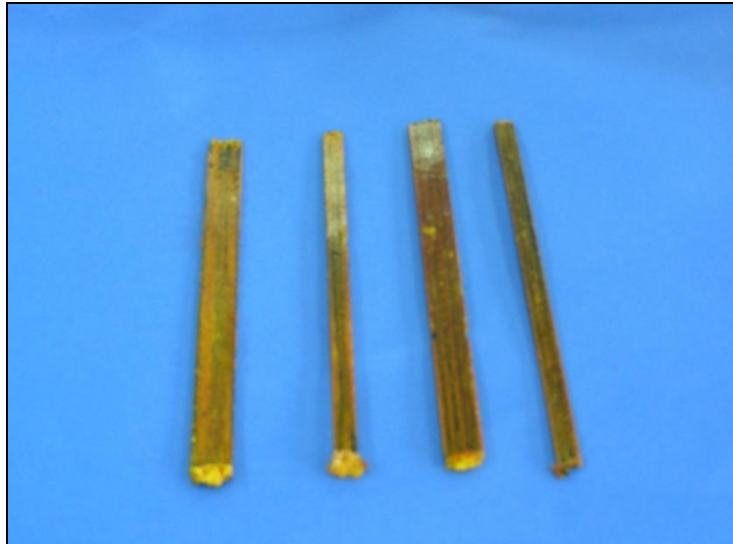
Σχήμα 8/4. Σύνθετα υλικά ρητίνης νεολάκης με ίνες άνθρακα (15 % v/v).
