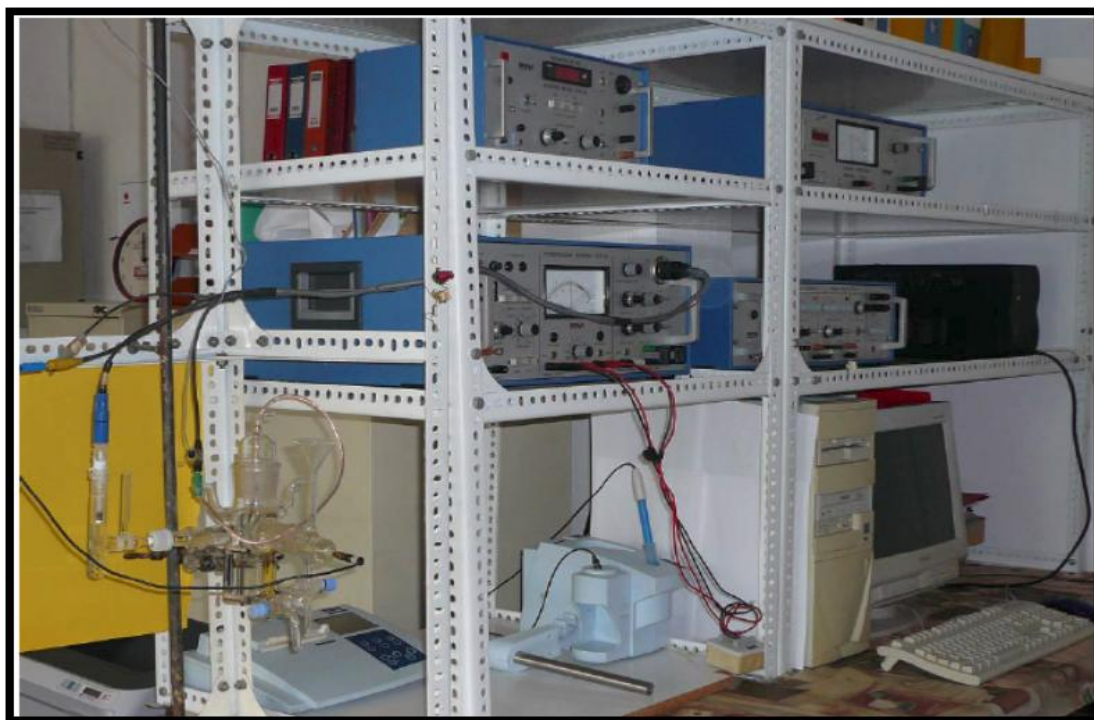
Σχήμα 6/2. Διάταξη ηλεκτροχημικής επεξεργασίας ινών άνθρακα.
