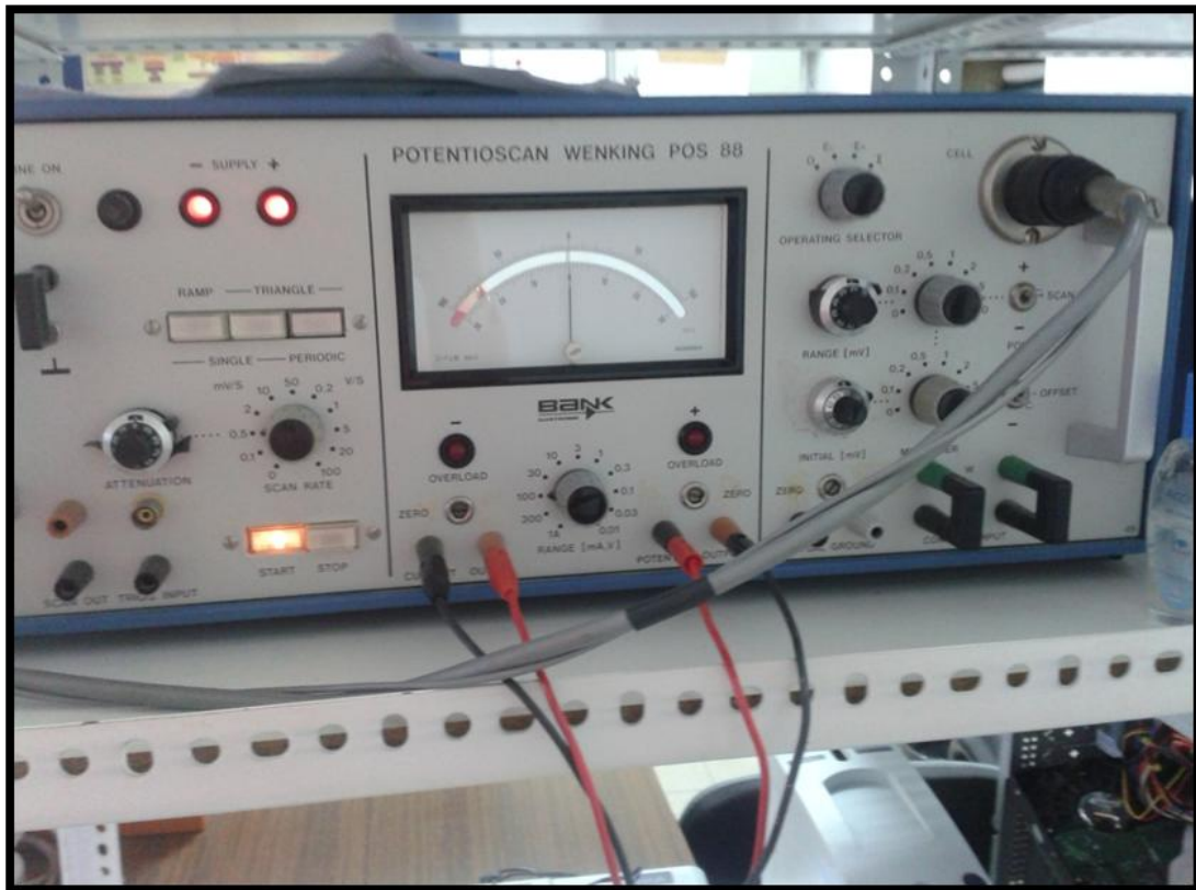
Σχήμα 6/3. Ποτενσιοστάτης τύπου POTENTIOSCAN WENKING POS 88 της διάταξης ηλεκτροχημικής επεξεργασίας ινών άνθρακα.
