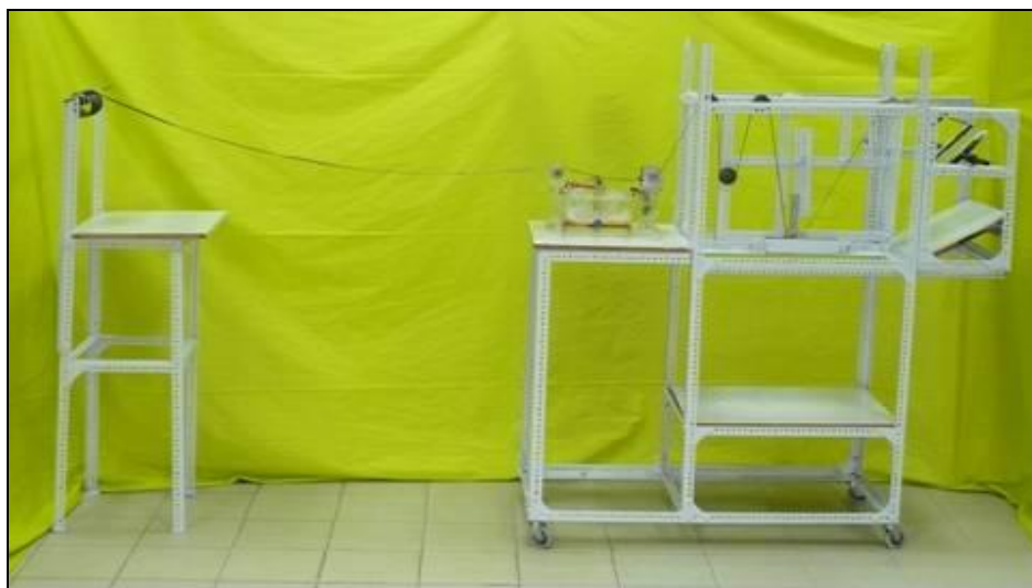
Σχήμα 8/2.: Εργαστηριακή διάταξη για προδιαπότιση των ινών άνθρακα
