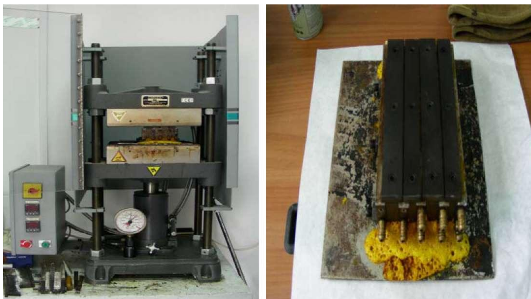
(α) (β) Σχήμα 8/3. (α) Θερμοπρέσα μορφοποίησης (β) Καλούπι (διακρίνεται και το σύνθετο υλικό μετά τη διαδικασία πρεσαρίσματος)
