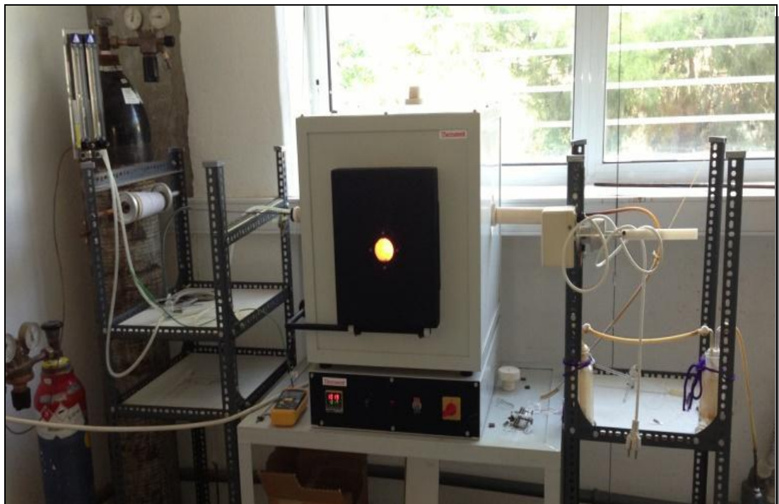
Σχήμα 9/4. Εργαστηριακή διάταξη χημικής εναπόθεσης από αέρια φάση (CVD).
