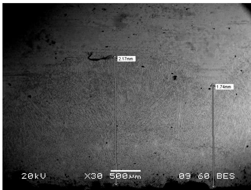
Εικόνα 5.25 Χαρακτηριστική μορφολογία επιστρώματος, όπου διακρίνονται τα πάσα και το βάθος της ζώνης τήξης (η επιφάνεια του δοκιμίου είναι από την κάτω μεριά).
