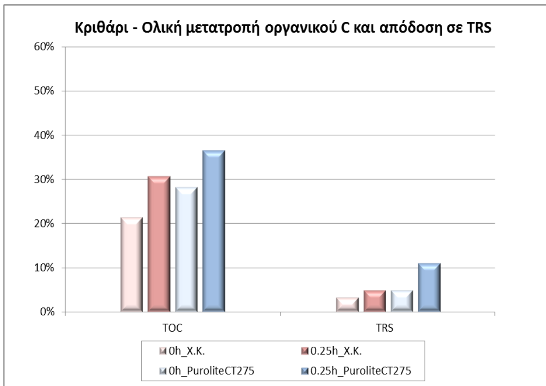
Διάγραμμα 19 : Μετατροπή του οργανικού μέρους της βιομάζας ( στελεχών κριθαριού ) σε προϊόντα αποικοδόμησης από θερμική / καταλυτική υδρόλυση με Purolite CT275: βιομάζα/νερό=10gr/200ml, βιομάζα/καταλύτη=10:1, T=180°C, t=0-0.25h
