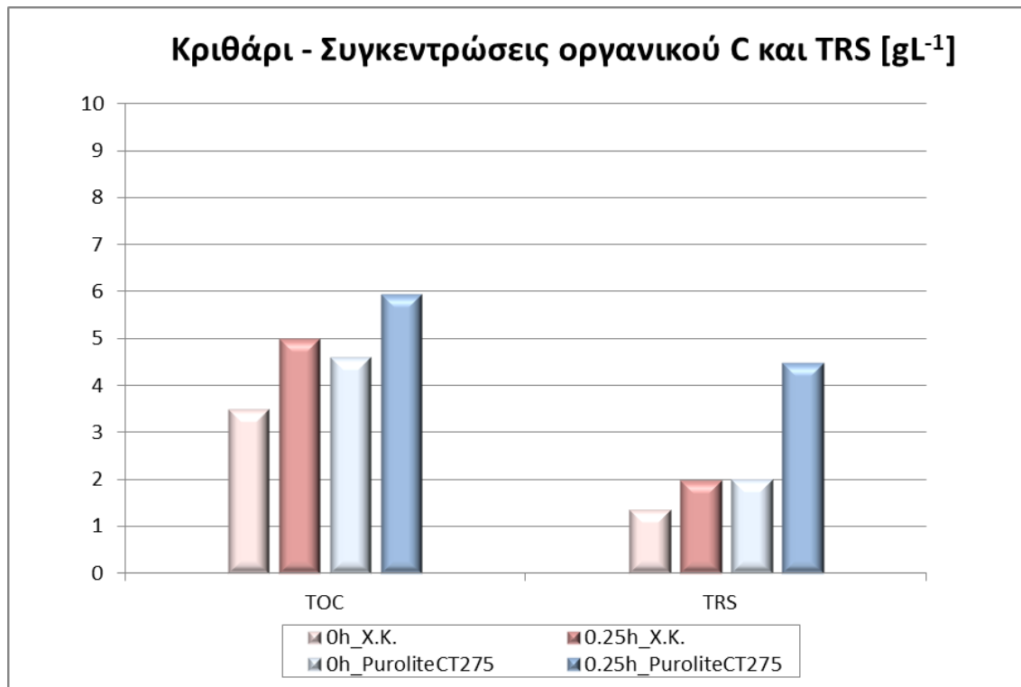
Διάγραμμα 18: Συγκεντρώσεις στο υγρό προϊόντων αποικοδόμησης από θερμική / καταλυτική υδρόλυση με Purolite CT275 στελεχών κριθαριού : βιομάζα/νερό=10gr/200ml, βιομάζα/καταλύτη=10:1, T=180°C, t=0 - 0.25h
