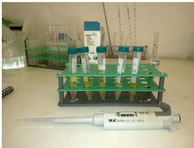
Εικόνα 5 : Λήψη υγρών δειγμάτων μετά από τη δεύτερη διήθηση
