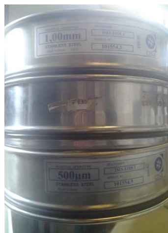
Εικόνα 6 : Αριστερά: Μίγμα ξηρής προκατεργασμένης βιομάζας και καταλύτη όξινης ρητίνης, Δεξιά: Τα κόσκινα που χρησιμοποιήθηκαν για το διαχωρισμό του καταλύτη.
