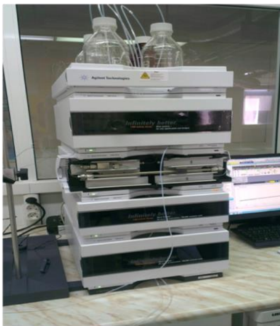
Εικόνα 8: Συσκευή Υγρής Χρωματογραφίας Υψηλής Πίεσης (HPLC), AGILENT TECHNOLOGIES, Model 1260 Infinity LC VL
