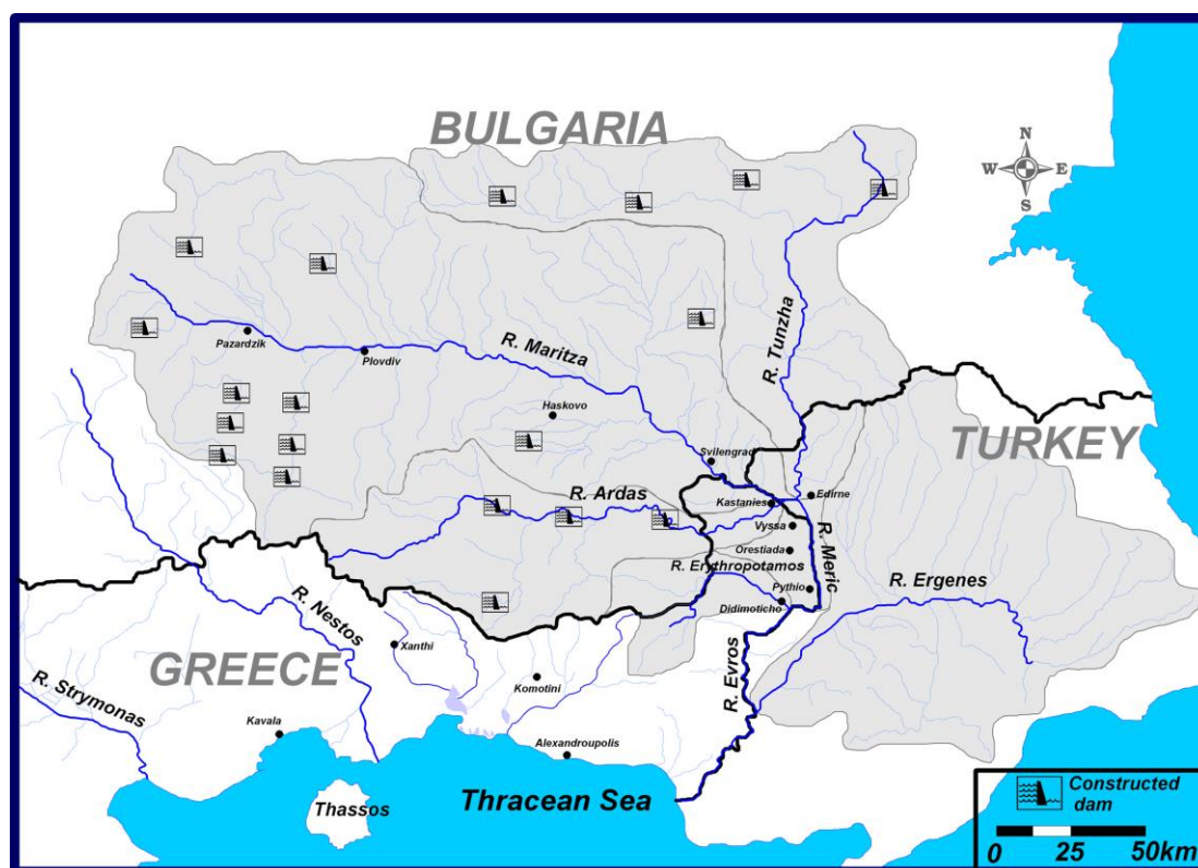
Σχήμα 4.6: Φράγματα στη λεκάνη απορροής του ποταμού Έβρου (Skias et al., 2013).
