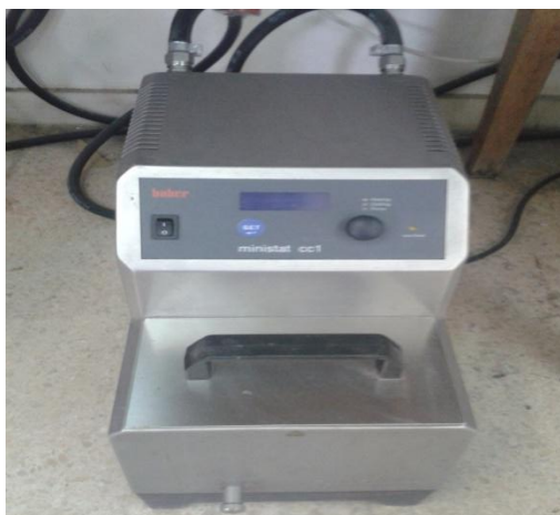
Εικόνα 32 - Εναλλάκτης θερμότητας (ψύκτης) εργαστηρίου ΤΧΔ
