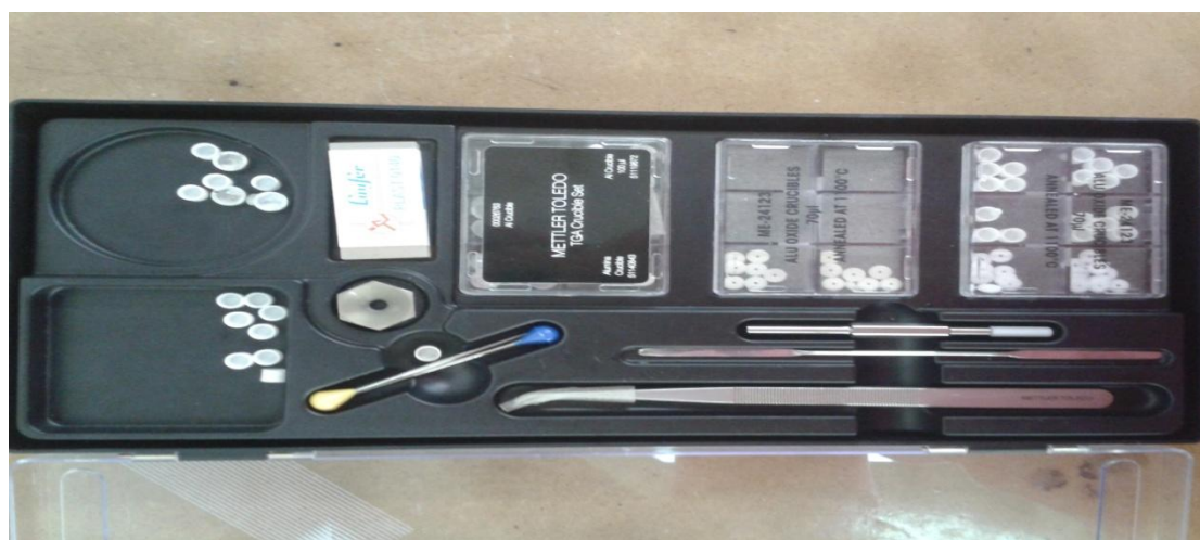
Εικόνα 36 - Περιφερειακά του θερμοζυγού. Αριστερά οι δειγματοφορείς δεξιά τους το εξάγωνο χωνί και στο κάτω δεξιά μέρος η λαβίδα.
