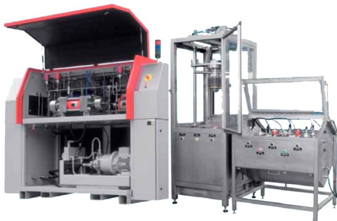
Εικόνα 5.1. Εργαστηριακή Μονάδα Υπερψηλής Πίεσης (Από αριστερά: κεντρική μονάδα ΥΠ, δοχείο ΥΠ όγκου 1,5L και, συστοιχία 6 δοχείων ΥΠ όγκου 42mL το καθένα)
